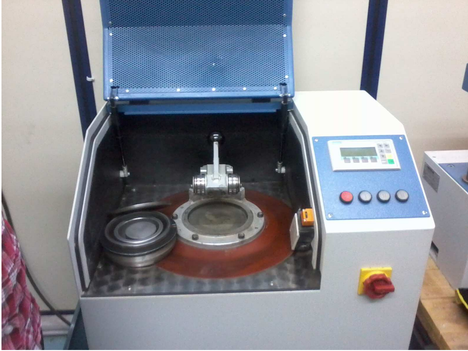
Şekil 4.1. İnci numunelerinin öğütüldüğü cihaz.
