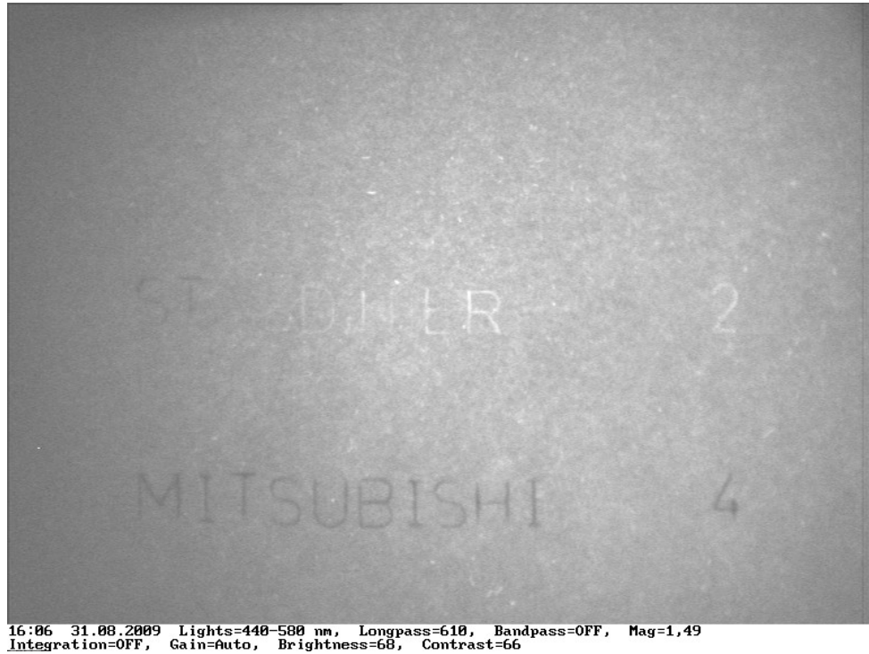
Şekil 19: VSC 2000’de 440-580 nm dalga boyunda kırmızı tükenmez kalem örneklerinin ekran görüntüsü.
