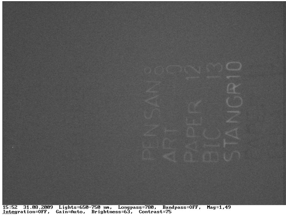
Şekil 31: VSC 2000'de 650-750 nm dalga boyunda siyah tükenmez kalem örneklerinin ekran görüntüsü.
