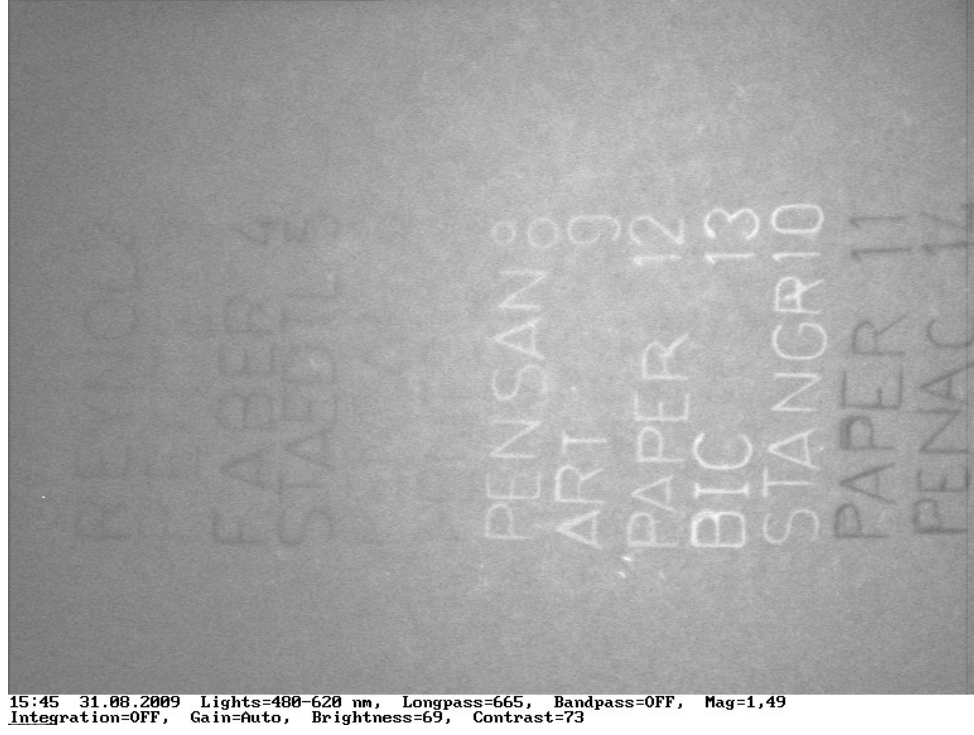
Şekil 22: VSC 2000'de 480-620 nm dalga boyunda siyah tükenmez kalem örneklerinin toplu görüntüsü.
