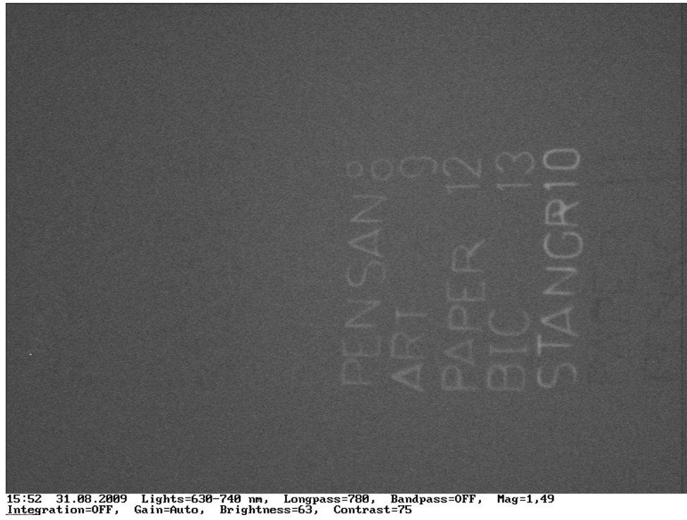
Şekil 29: VSC 2000'de 630-780 nm dalga boyunda siyah tükenmez kalem örneklerinin ekran görüntüsü.
