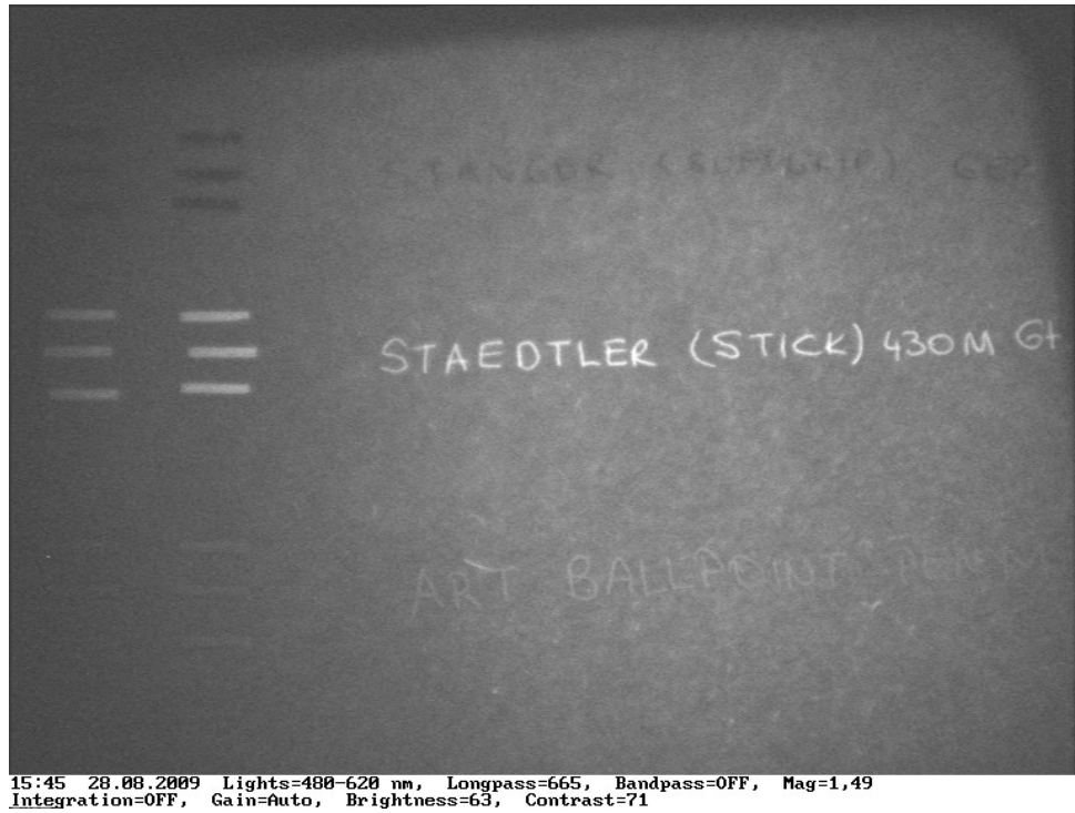
Şekil 9: VSC 2000'de 480-620 nm dalga boyunda mavi tükenmez kalemlerden üç örneğin ekran görüntüsü.
