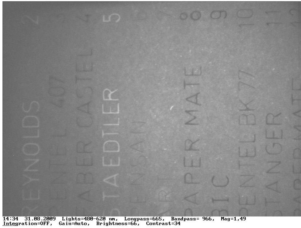
Şekil 21: VSC 2000’de 480-620 nm dalga boyunda mavi tükenmez kalem örneklerinin toplu ekran görüntüsü.
