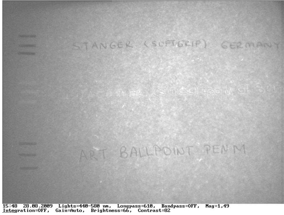
Şekil 20: VSC 2000’de 440-580 nm dalga boyunda mavi tükenmez kalemlerden üç örneğin ekran görüntüsü.
