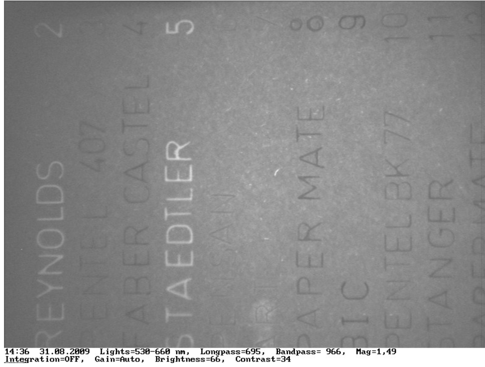
Şekil 24: VSC 2000’de 530-660 nm dalga boyunda mavi tükenmez kalem örneklerinin ekran görüntüsü.
