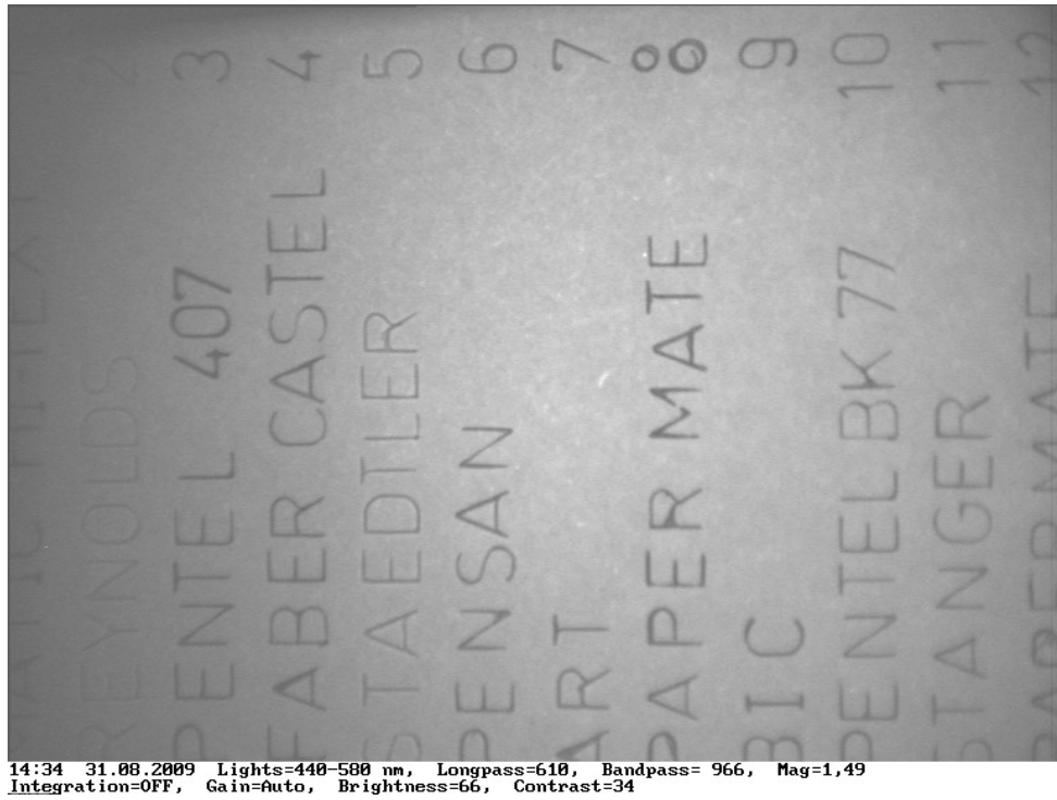
Şekil 17: VSC 2000’de 440-580 nm dalga boyunda mavi tükenmez kalem örneklerinin toplu ekran görüntüsü.
