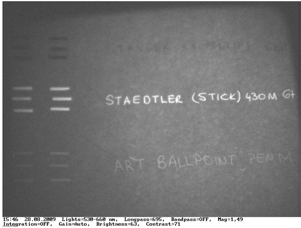
Şekil 13: VSC 2000’de 530-660 nm dalga boyunda mavi tükenmez kalemlerden üç örneğin ekran görüntüsü.
