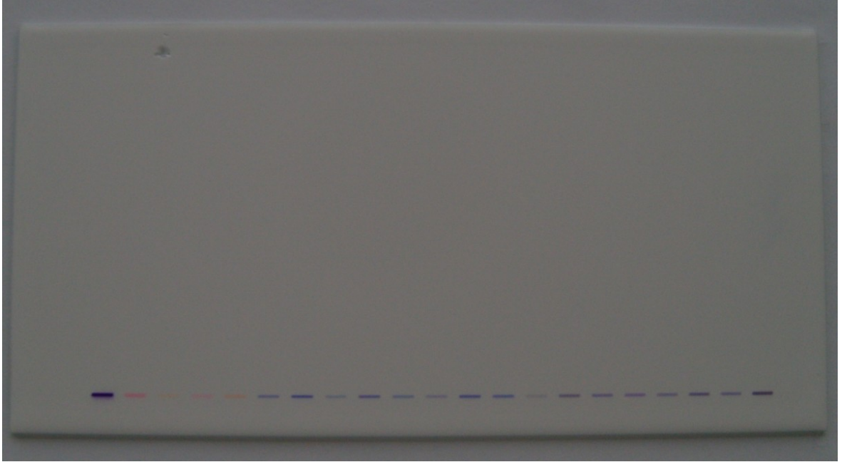
Şekil 8: Silika jel plağında yürütülmüş mürekkep örneği spotları.
