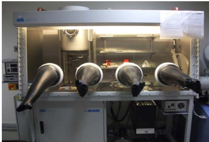
Şekil 4.7. Elektriksel ölçümlerin yapıldığı glove box sistemi
