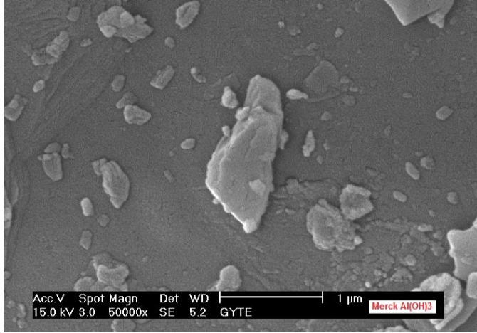
Şekil 4.23. Merck \text{Al}(\text{OH})_3 'ün 50000 kat büyütülen SEM görüntüsü
