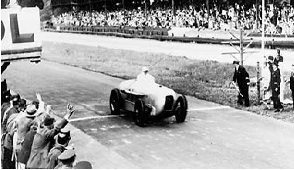
Resim 3.13: SSKL– 7 litreden fazla motor boşluğu,300 HP çıkış,235 km/h hız 203
