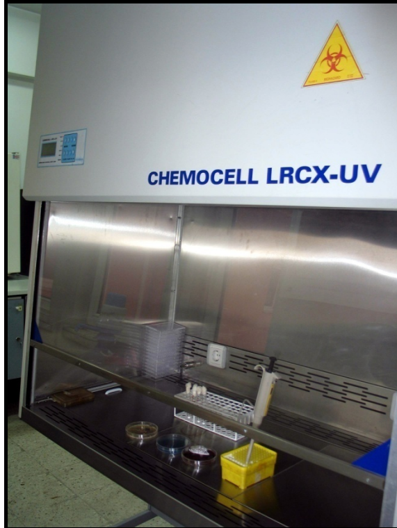
Şekil 2.8. Örneklerin dilüsyon ve ekiminde kullanılan steril yatay hava akımı (Laminar flow) cihazı
