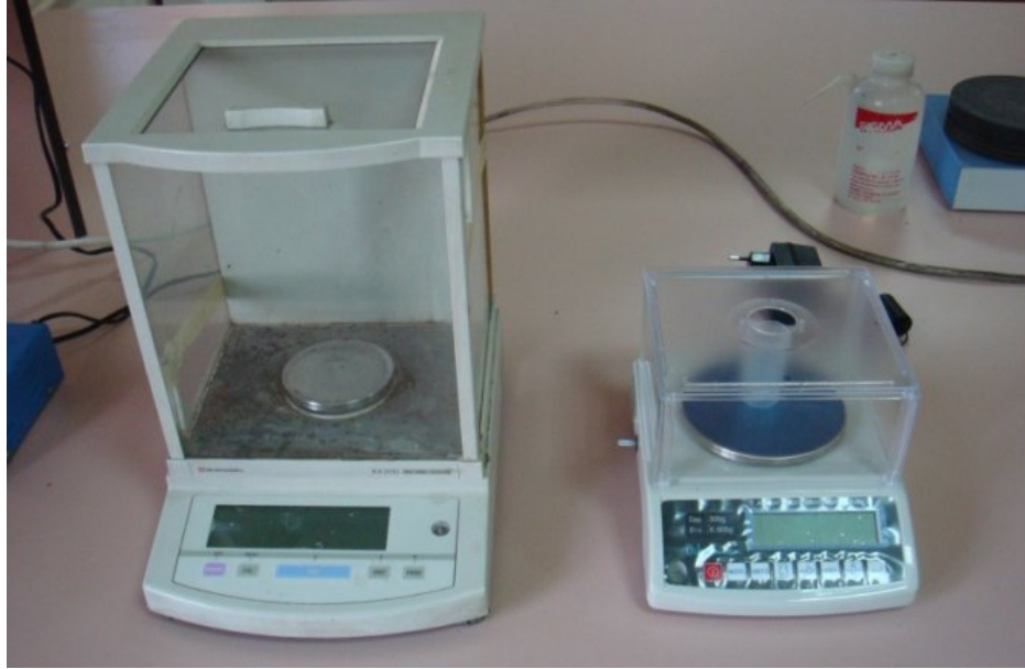
Şekil 12. Ana arı canlı ağırlığını belirlemede kullanılan hassas teraziler
