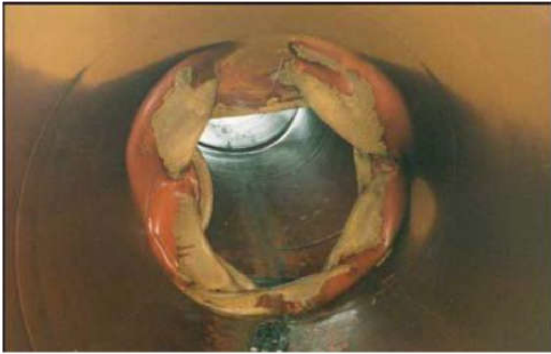
Şekil 2.5: Boruda fay kırığı hareketi sonucu oluşan buruşma (Eidinger, 1998).
