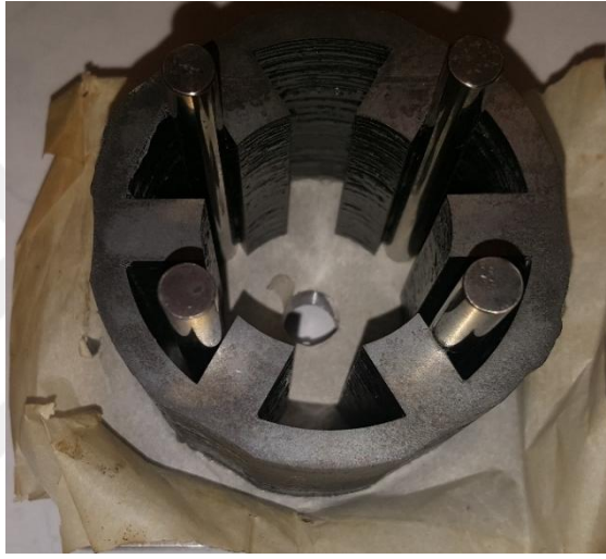
Şekil 3.6 Fırınlama işlemi sonrası yapışmış stator laminsyon yığını
