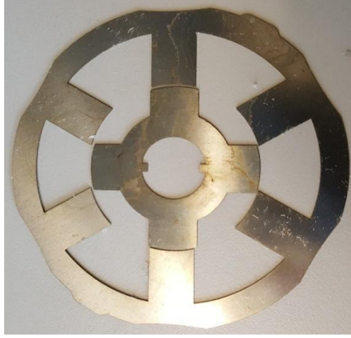
Şekil 3.2 tel erozyon yöntemi ile kesilmiş stator ve rotor laminasyonu
