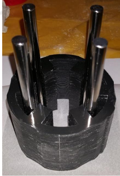
Şekil 3.4 Fikstür yardımıyla laminasyonların üst üste dizilmesi
