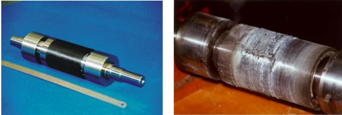
Şekil 1.11 Kalıcı mıknatıslı senkron motorda rotorun 35 bin d/d'da statora sürtmeden önceki ve sonraki hali [4],[7]
