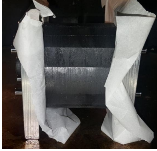
Şekil 3.5 Fikstür yardımıyla dizilen laminasyonların sıkıştırılması ve fırınlama işlemi
