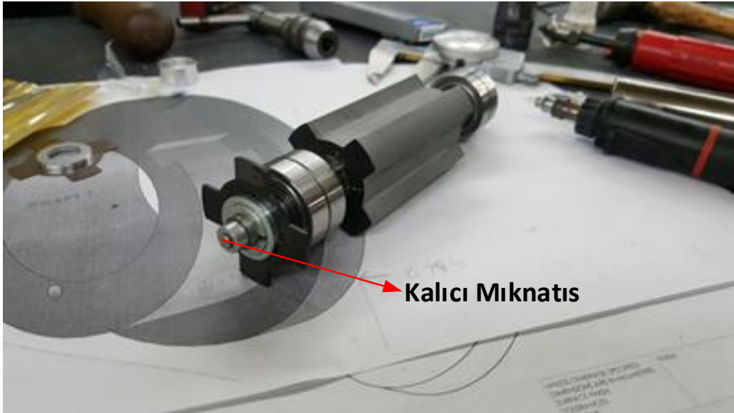
Şekil 3.10 Pozisyon ölçümü için şaft üzerine yerleştirilmiş kalıcı mıknatıs
