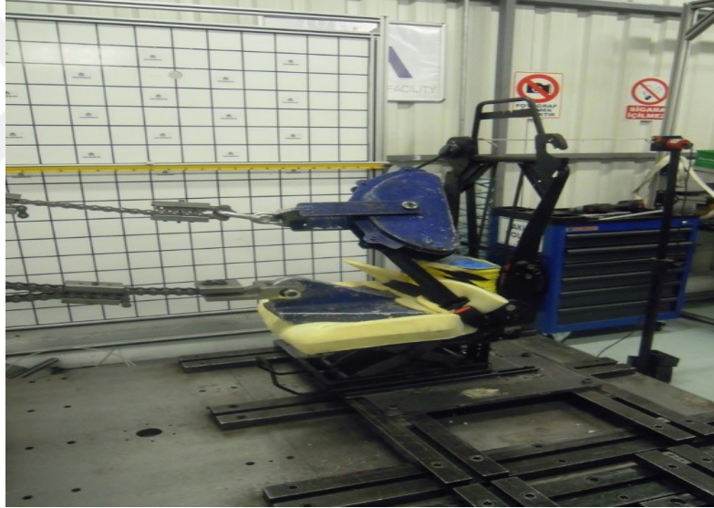
Şekil 4.9. Mekanik test öncesi ön çekme yükleri altındaki prototip muavin koltuğu görüntüsü
