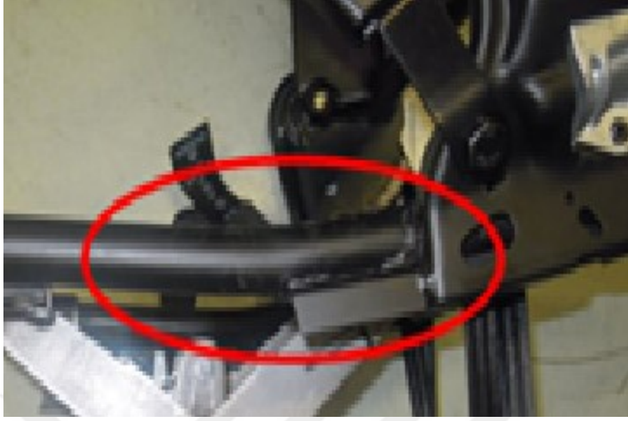
Şekil 4.15. Mekanik test sonrasındaki koltuk oturak grubu boru profil bölgesi
