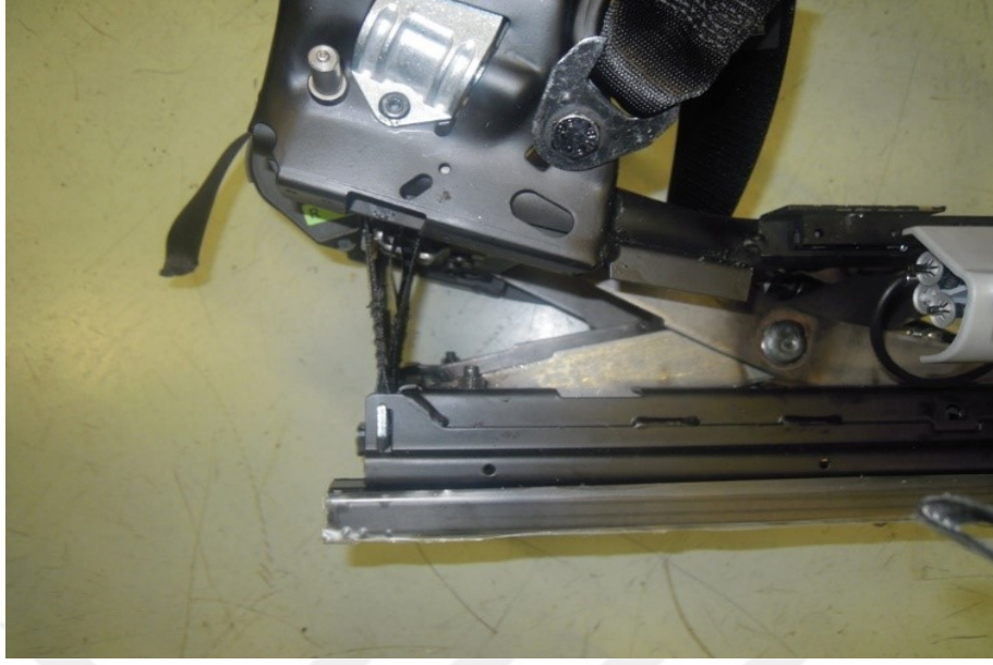
Şekil 4.17. Mekanik test sonrasındaki koltuk ikincil kemer bölgesi
