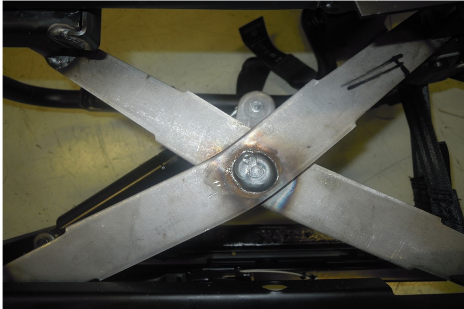
Şekil 4.20. Mekanik test sonrasındaki koltuk statik makas görüntüsü
