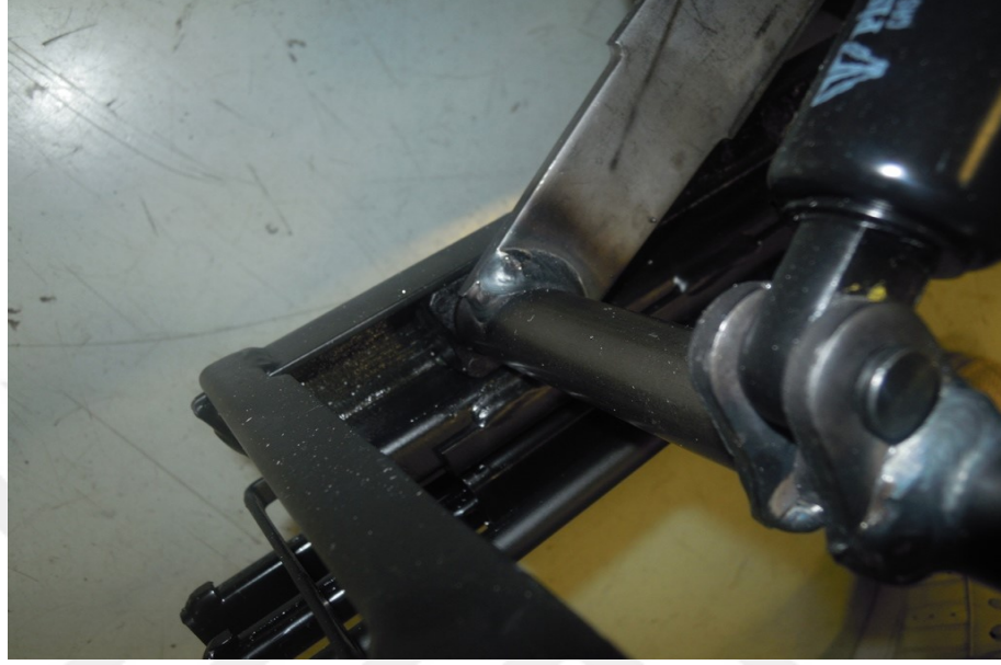
řekil 4.21. Mekanik test sonrasındaki koltuk alt makas ve gaz piston baėlantı blgesi
