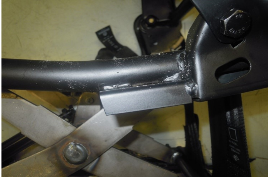
Şekil 4.18. Mekanik test sonrasındaki koltuk oturak boru profil bölgesi
