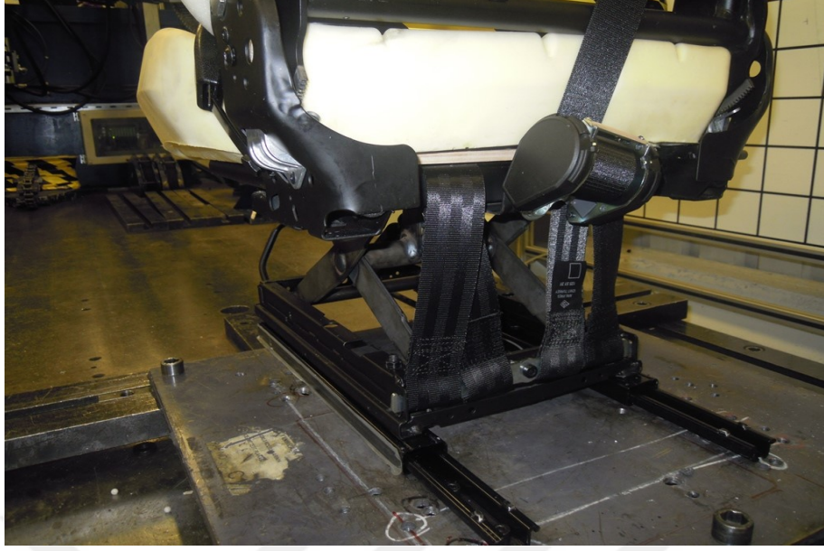
Şekil 4.11. Mekanik test öncesi prototip muavin koltuğu görüntüsü
