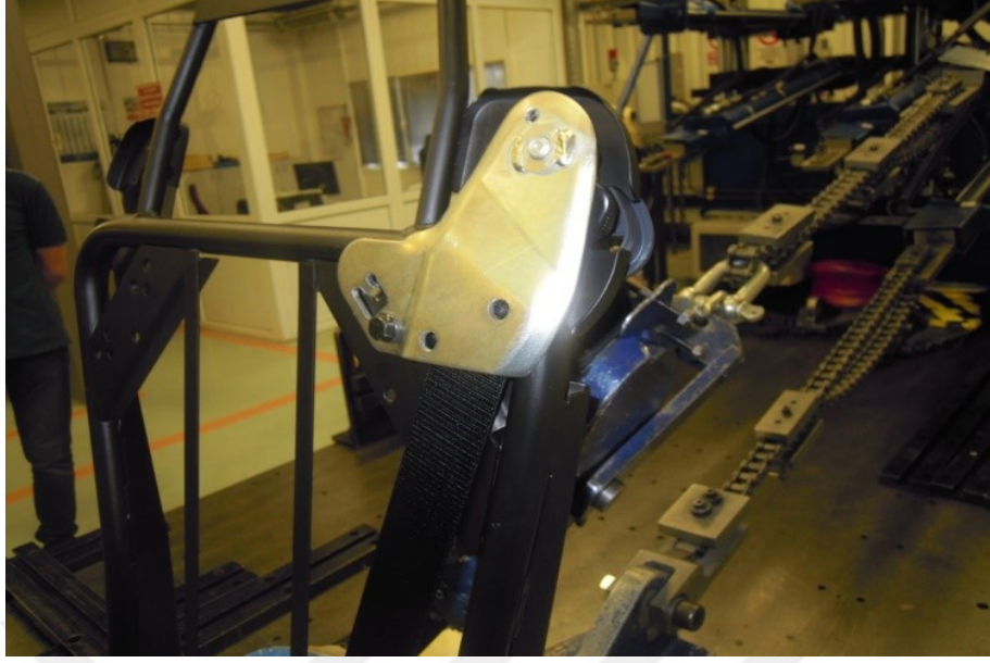
Şekil 4.14. Test sonrasındaki koltuk arkalık iskeleti üst emniyet kemer bölgesi
