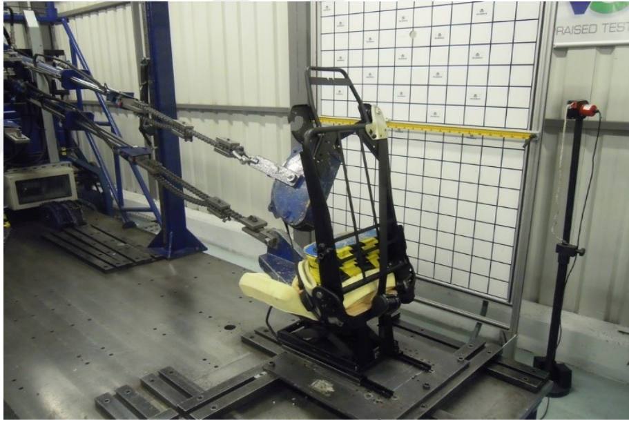
Şekil 4.12. Test esnasındaki çekme kuvvetleri etkisindeki prototip koltuk görüntüsü
