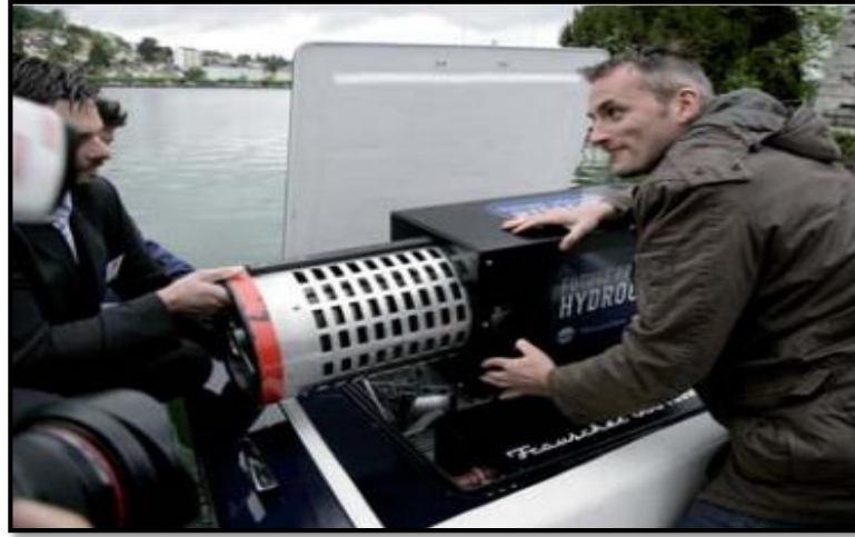
Şekil 3.7 Değiştirilebilir hidrojen kartuşu (Pagliaro ve diğer., 2010)
