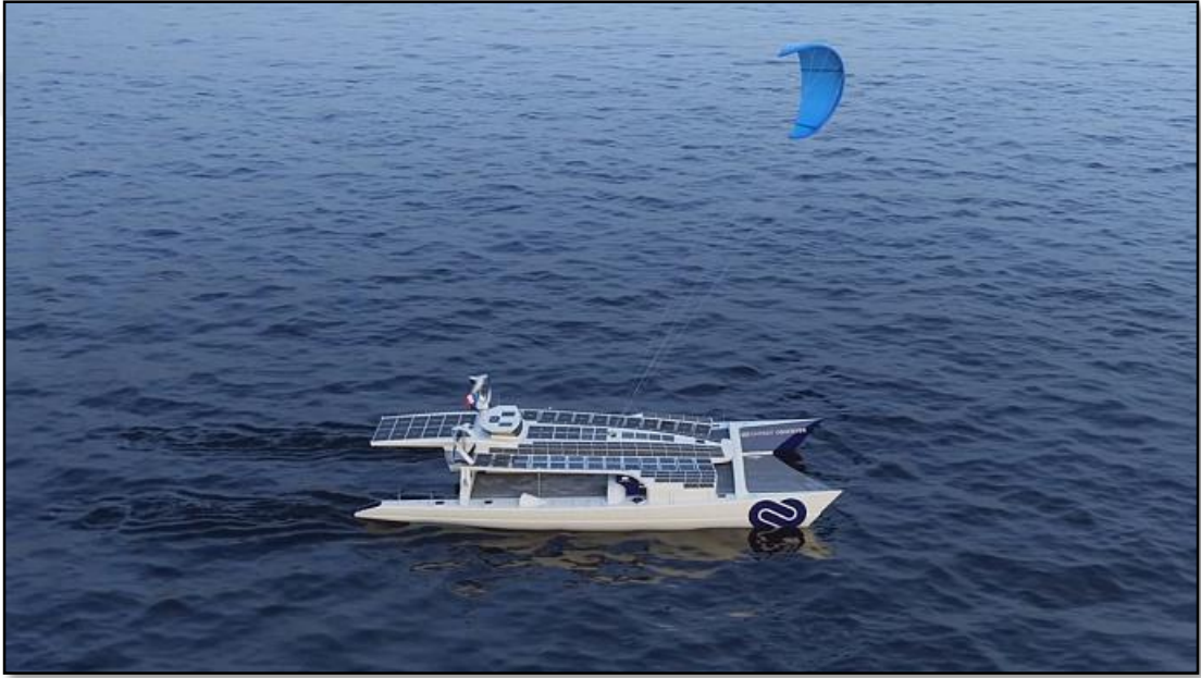
Şekil 3.20 Teknenin ekstra çekiş gücünü sağlayan uçurtma ile seyri (Euronews, 2017)
