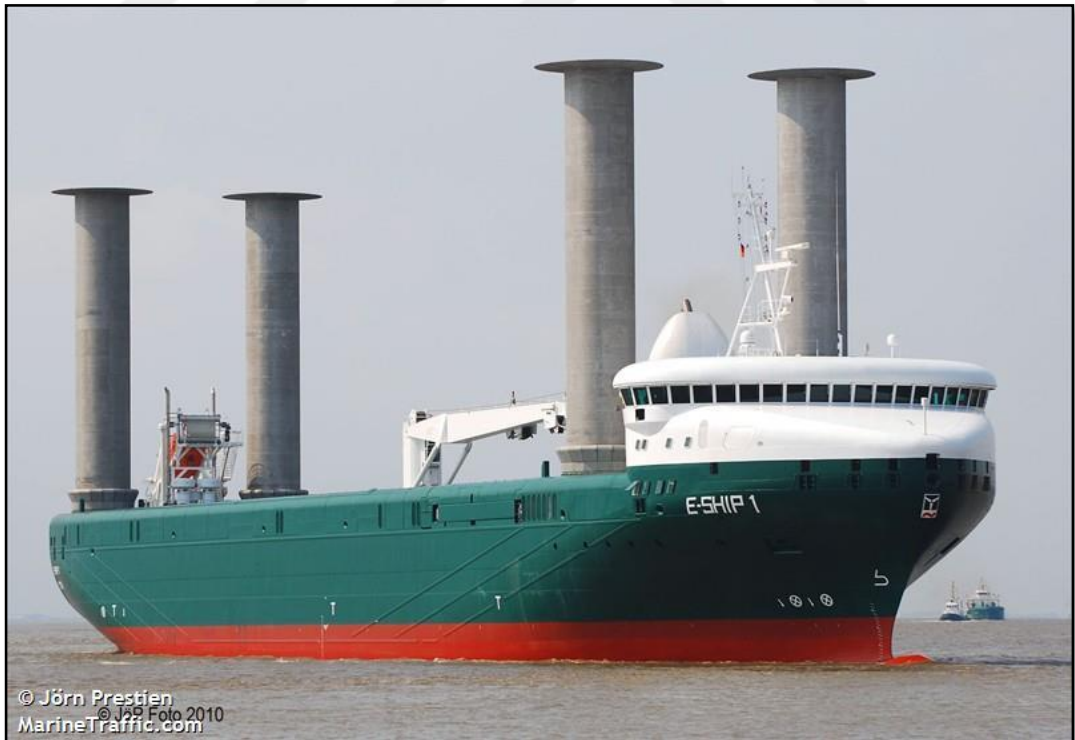
Şekil 2.9 E-SHIP 1 gemisi ve Flettner rotorları (Prestien, 2010)
