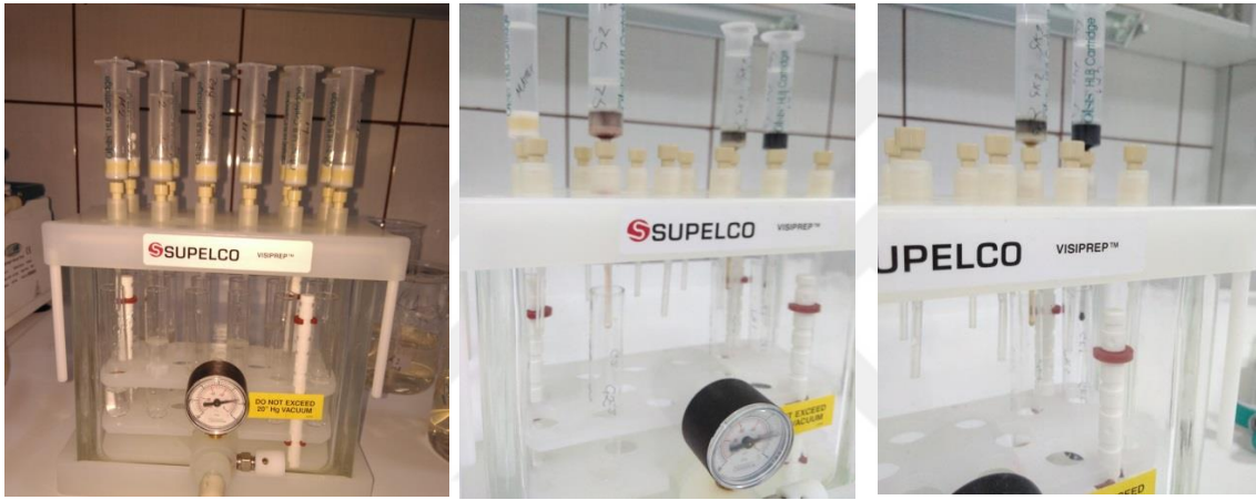
Resim 4.2 3. Vakumlu Manifold ile şartlandırılmış kartuşlarla filtrasyon
