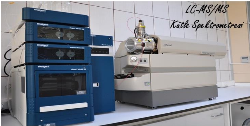
Resim 4.2.1. İncelenen evsel ve endüstriyel atıksu numunelerinin antibiyotik karakterizasyonunun yapıldığı HPLC/MS-MS cihazı
