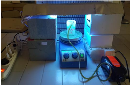
Resim 4.4.3.1. İmmobilize PS/Cup-N ve PS/Cup-NFC fotokatalistlerle fotokatalitik oksidasyon deney düzeneği görüntüsü
