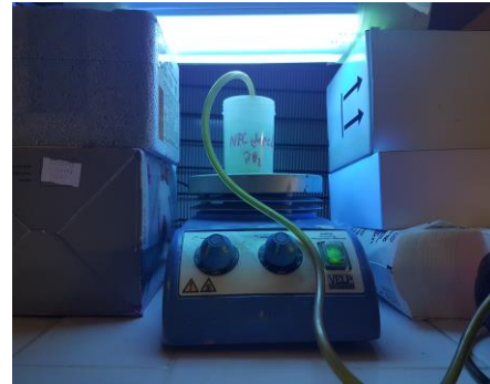
Resim 4.4.3.1. İmmobilize PS/Cup-N ve PS/Cup-NFC fotokatalistlerle fotokatalitik oksidasyon deney düzeneği görüntüsü
