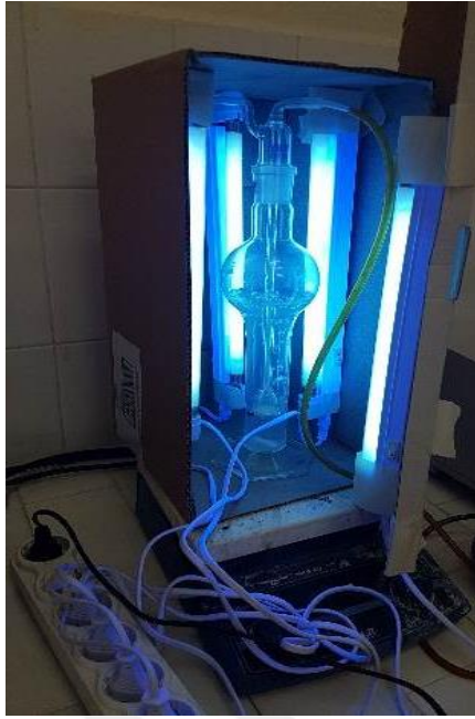
Şekil 4.4.1. Toz formdaki N-doplu ve NFC-doplu \text{TiO}_2 fotokatalistlerle IOP Deney Düzenegi
