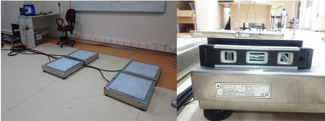
Resim 3: Yük hücreleri ve analiz sistemi bağlantısı, denge ayarı
