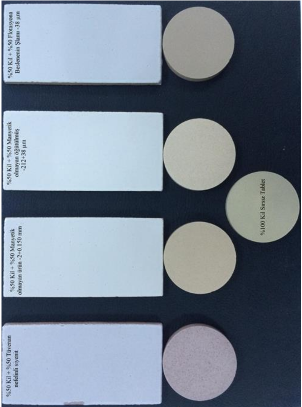
EK 4. Tüvenan Kırşehir nefelinli siyenit ve zenginleştirme aşamalarından alınan numunelerin %50 kil girilerek yer karosu şartlarında pişirilmiş sırsız ve sırlı tabletlerin görüntüleri
