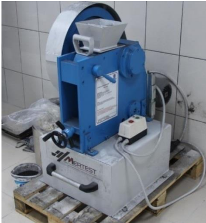
Şekil 3.2. Laboratuvar tipi çeneli kırıcı
