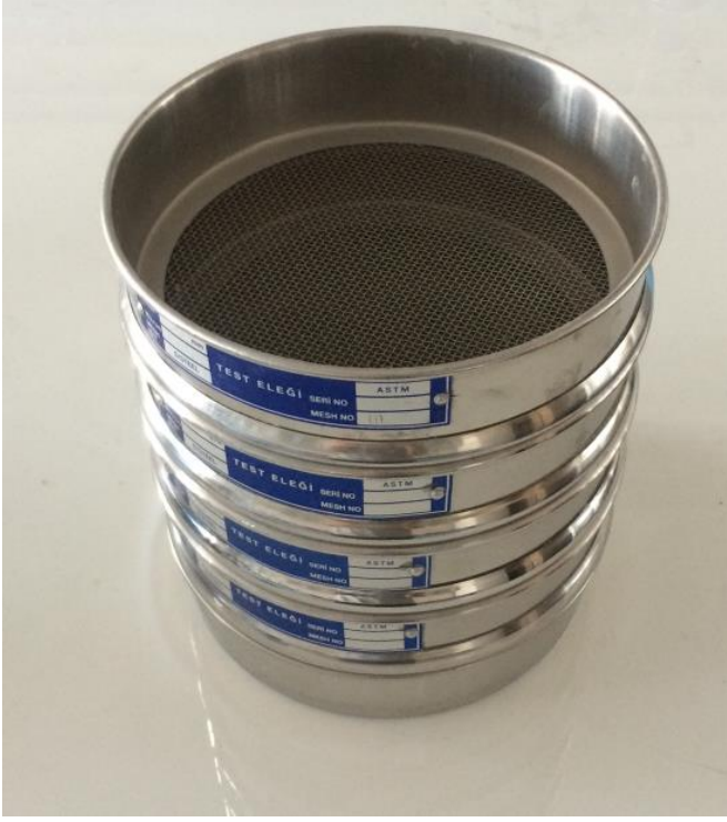
Şekil 3.3. Eleme işlemlerinde kullanılan Tyler elek serisi
