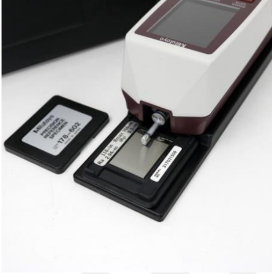
Şekil 3.14. Mitutoyo Surftest SJ 210 yüzey pürüzlülüğü ölçüm cihazı
