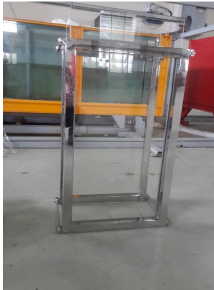
Şekil 3.8 Keson modelin yerleştirildiği genişliği ayarlanabilir yan yüzeyleri pleksiglas kılıf
