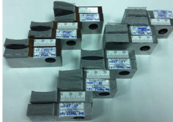
Şekil 2.12. Kırılma tokluğu testi sonucunda çelik malzemelerin perspektif görünümü.
