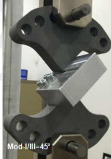
Şekil 2.132. Çatlak ilerleme başlangıç noktasının tespiti için, mod-I/III yüklemeye açısında CTT numunesi için gerçekleştirilen testten bir kesit.
