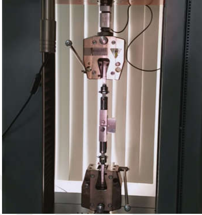
Şekil 2.10. Zwick marka 50 kN kapasiteli çekme cihazı.
