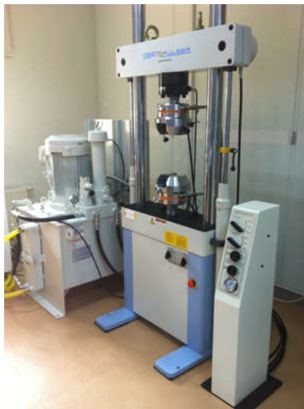
Şekil 2.13. Shimadzu 100 kN kapasiteli eksenel yorulma cihazı.
