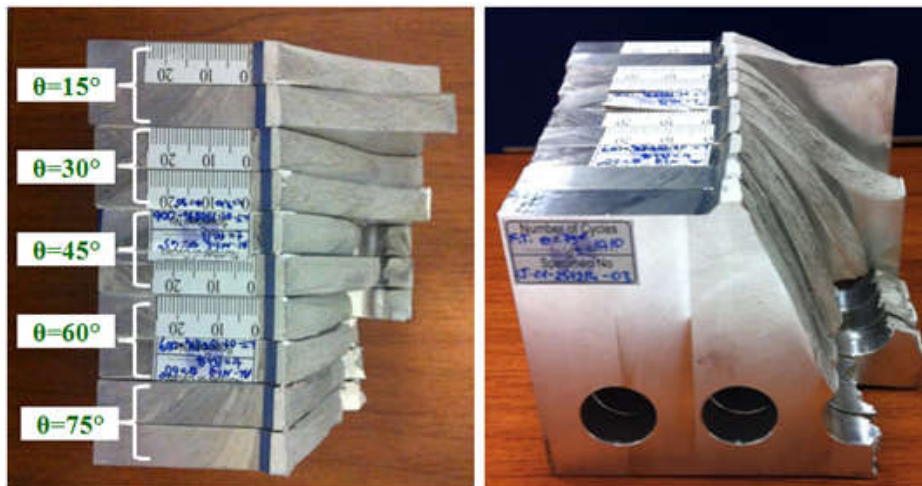
Şekil 2.37. Farklı açılarda kırılan numune yüzeylerinin perspektif görünümü.
