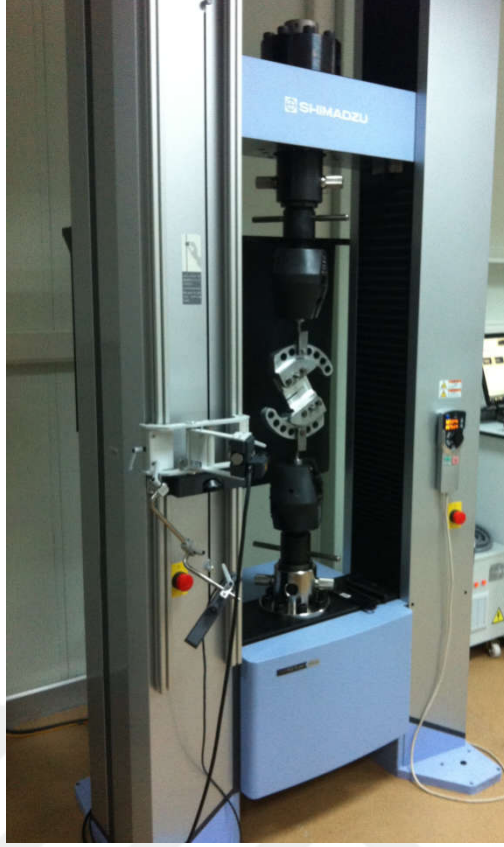
Şekil 2.35. Shimadzu 200 kN kapasiteli eksenel çekme cihazı.
