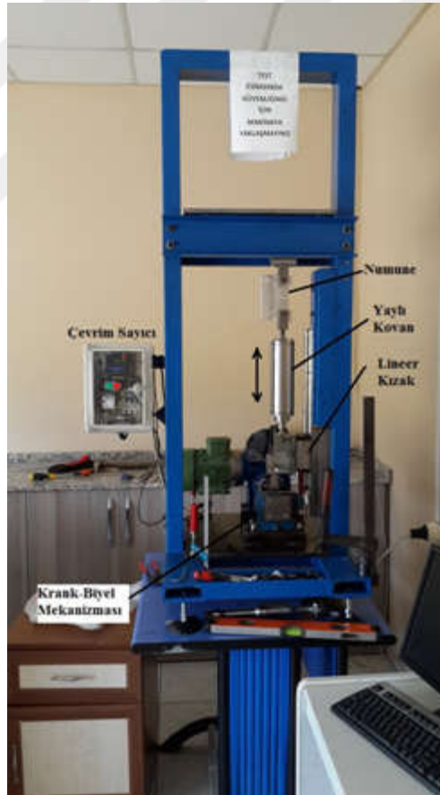
Şekil 2.7. Yorulma ön çatlaklarının oluşturulması için imal edilen yorulma cihazı.
