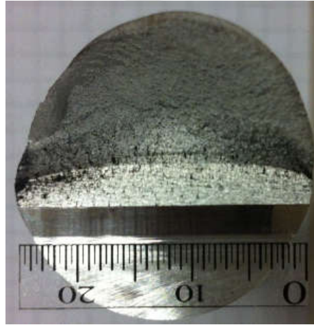
Şekil 4.32. 17 kN eksenel yük ( R=0,1 ) ve 136 Nm ( R=0,1 ) burulma momenti etkisinde kırılan numune yüzeyinin üstten görünümü.
