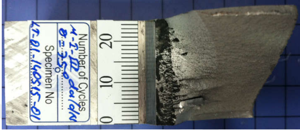
Şekil 3.27. Mod-I/III 75° yüklemesi açısında, 25 mm kalınlığına sahip CTT numunesi için yapılan çatlak ilerleme deneyi sonrasında kırılan numune yüzeyinin görünümü.
