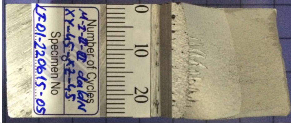
Şekil 3.34. Mod-I/II 45°, mod-II/III 45° ve mod-I/III 45° yüklem açısında, 25 mm kalınlıkta CTST numunesi için gerçekleştirilen çatlak ilerleme testi sonrasında kırılan numune yüzeyinin görünümü.
