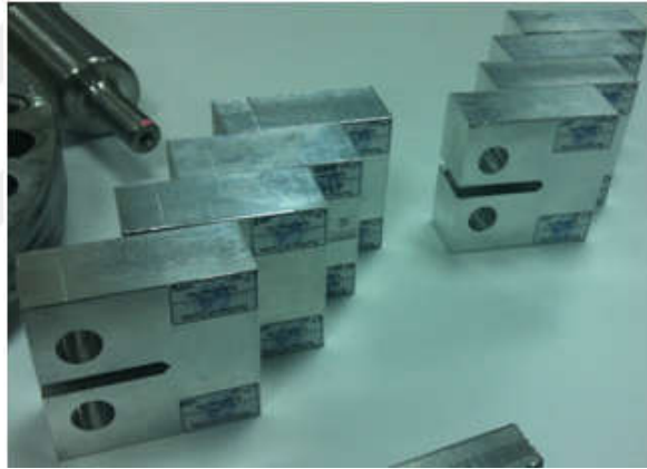
Şekil 2.16. Mod-I çatlak ilerleme testi için hazırlanan numunelerin perspektif görünümü.
