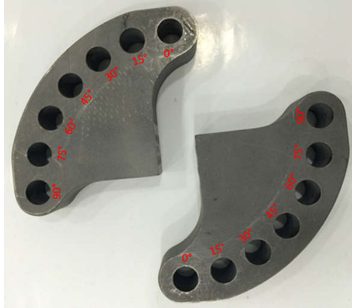
Şekil 2.72. Mod-I/III CTT numune tutucusu.
