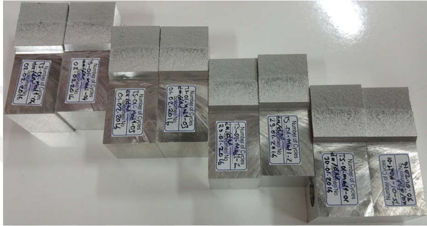
Şekil 5.5. TS hadde yönündeki CT numuneleri için gerçekleştirilen mod-I çatlak ilerleme testleri sonrası kırılan numune yüzeylerinin genel görünümü.
