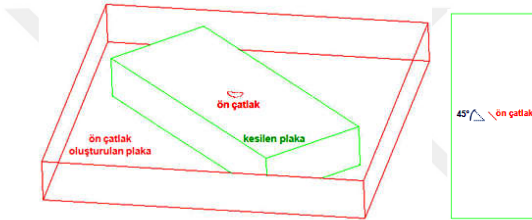
Şekil 4.6. Mod-I yüklemesi altında ön çatlak oluşturulmasının ardından belirli açılarda plakalar kesilerek çatlakın plaka kenarlarına açılı olarak yerleştirilmesinin sağlanması.
