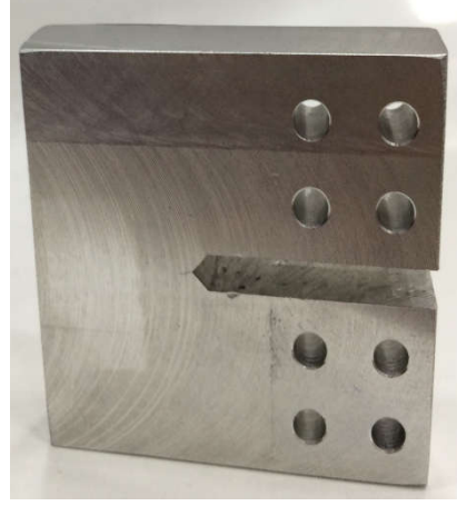
Şekil 2.71. 12,5 mm kalınlıktaki mod-I/III CTT numunesi.
