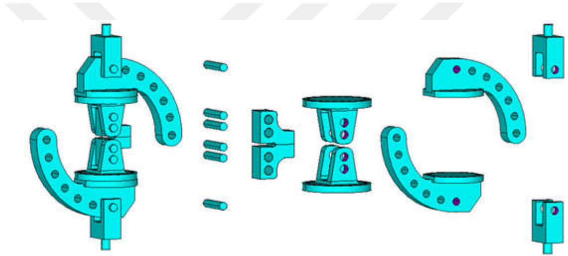
Şekil 2.78. Mod-I/II/III yüklemesi için tasarlanan T-numune tutucusu ve aparatları.
