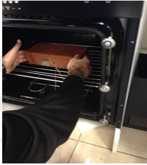
Şekil 2.6. Tuğlanın kaviteye yerleştirilmesi
