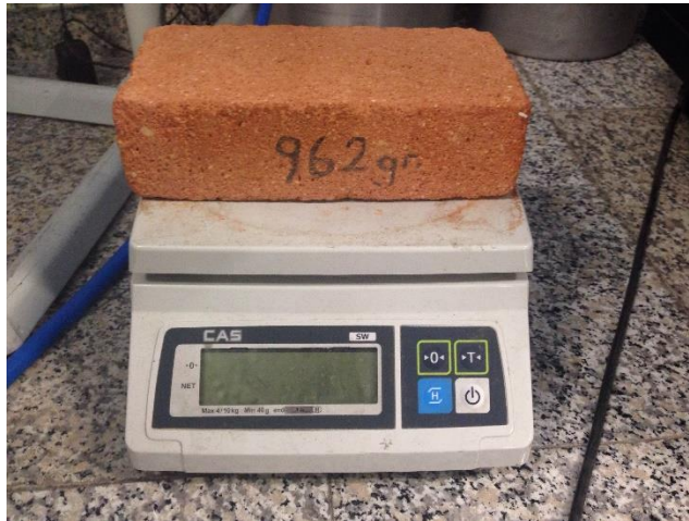
Şekil 2.5. Soğutucudan çıkan tuğlanın nemli ağırlığının tartılması
