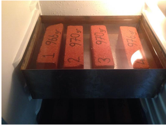
Şekil 2.4. Deney tuğlalarının soğutulması
