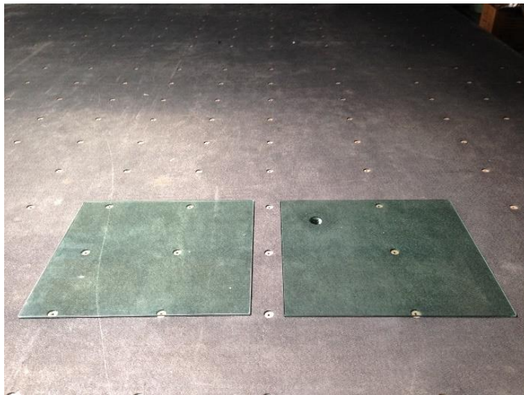
Şekil 2.11. Yüksek sıcaklığa dayanıklı temperli camlar
