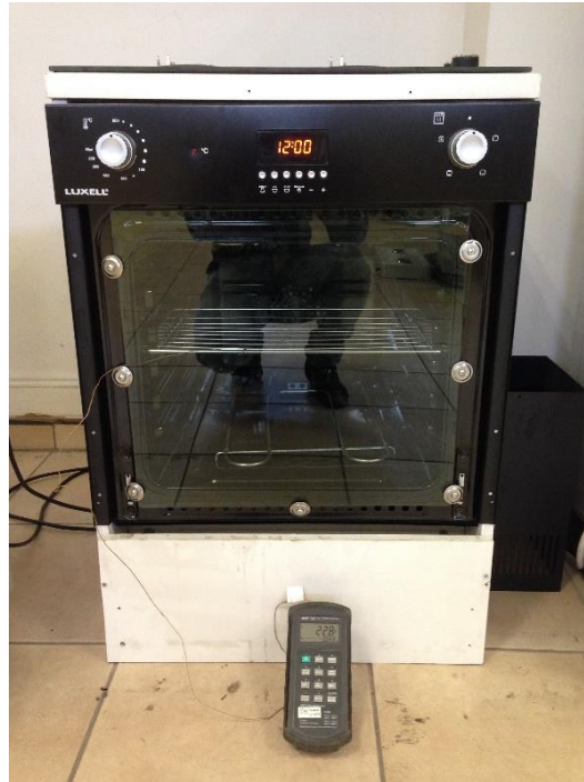
Şekil 2.7. Fırın sıcaklığının termik elemanlarla ölçülmesi
