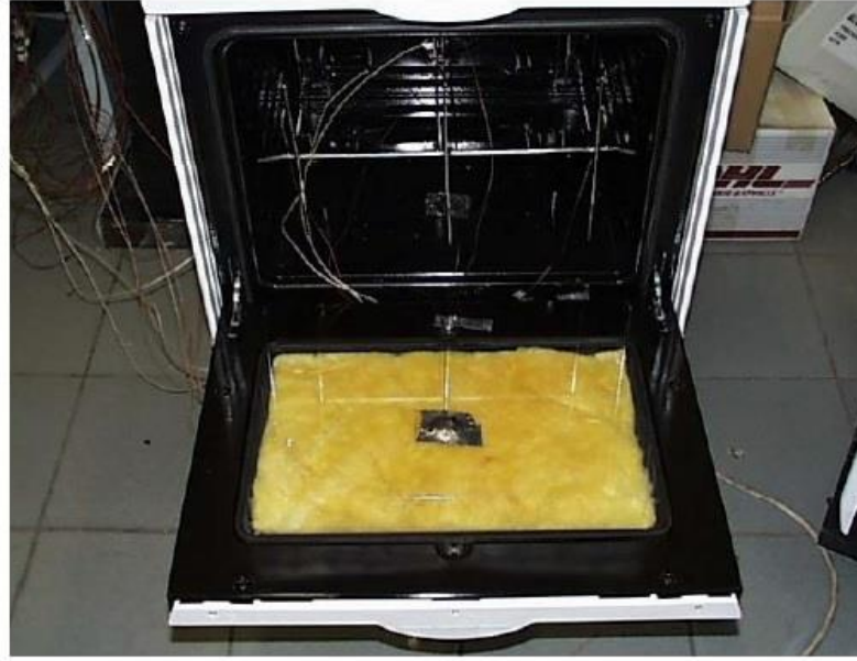
Şekil 1.9. Fırın kapağının tamamen izole edilmesi [32]
