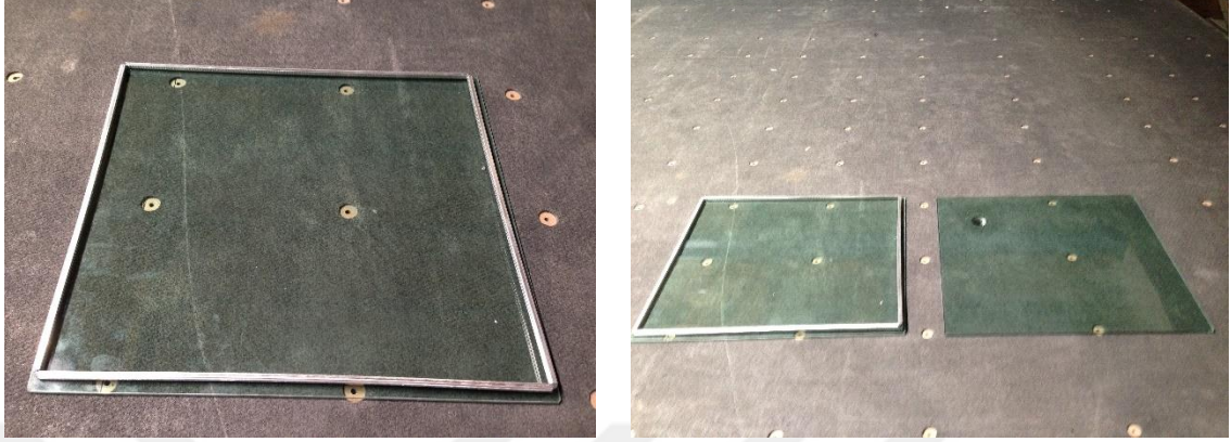
Şekil 2.14. Alüminyum çerçevenin temperli cam üzerine yerleştirilmesi
