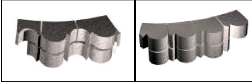
Şekil (14): Emir Tenkuzboğa Türbelerinin kubbelerinde kullanan gelişme tekniği (Tantawy)
