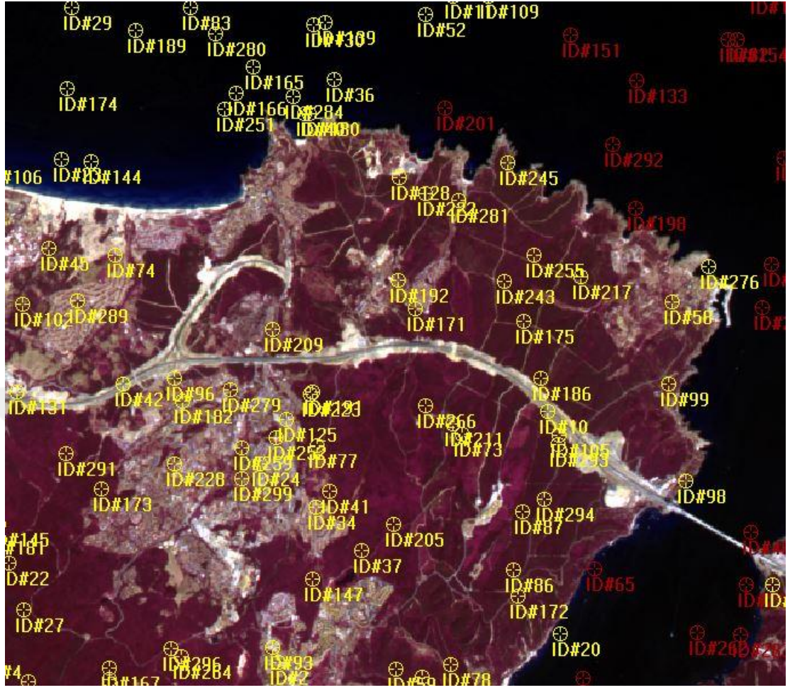
Şekil 3.24: ERDAS Imagine ile doğruluk analizinde kullanılmak üzere rastgele nokta atılması.
