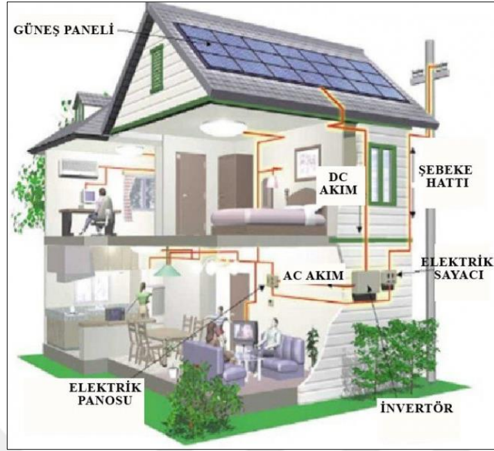
Şekil 3.11 Çatı üzeri şebeke bağlantılı fotovoltaiik sistemler
