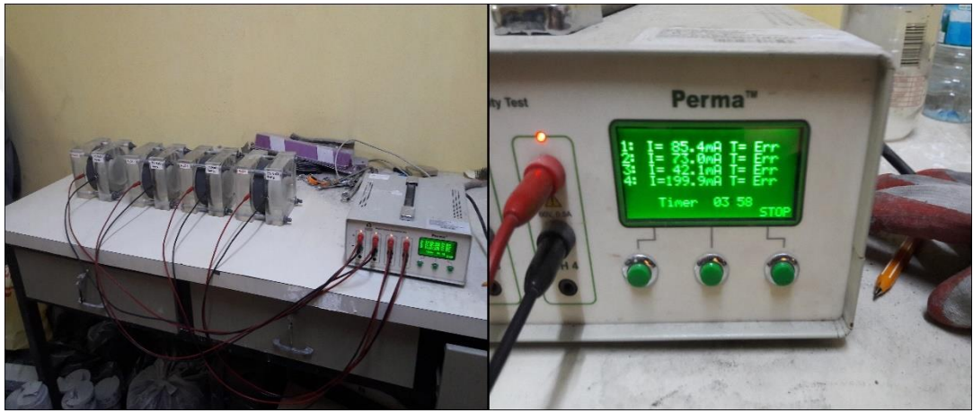
Şekil 3.6. Hızlı klorür iyonu geçirirmliliği deney düzeneği
