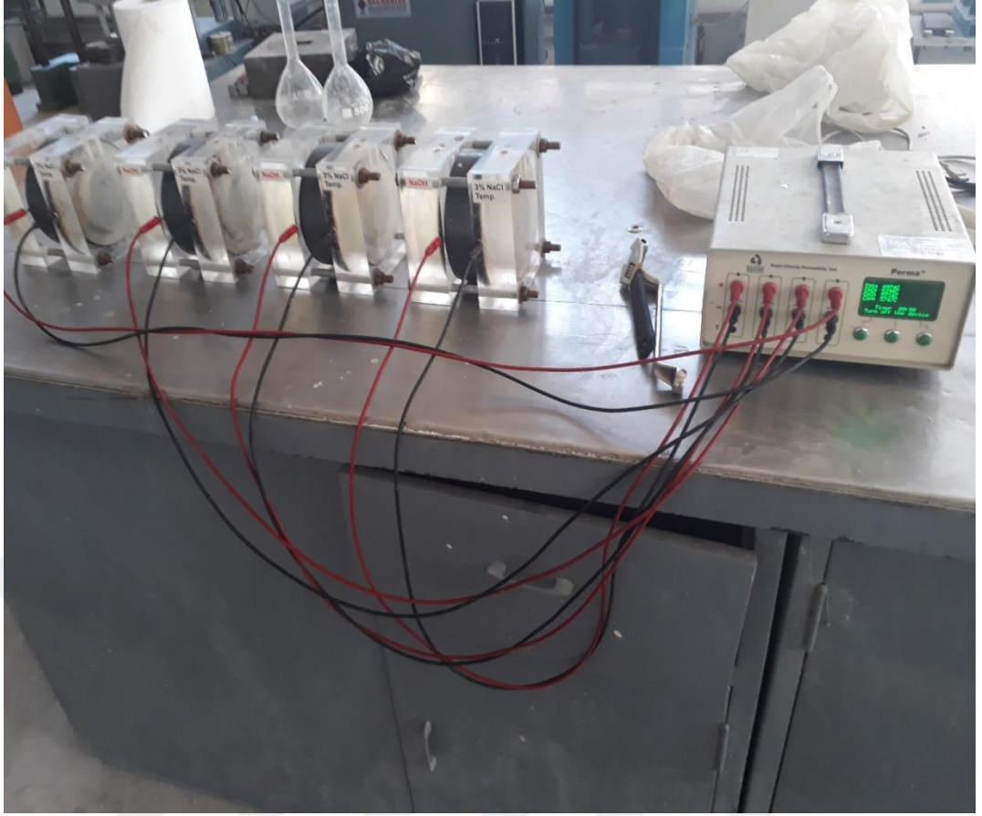
Şekil 5.30. Hızlı klorür iyonu geçirimsizliği numune kanalları ve bağlı olduğu veri kaydedici
