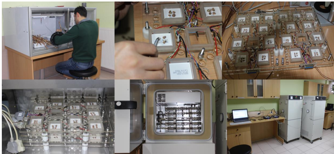
Şekil 3.3. DTA için örneklerin hazırlanma aşamasından genel bir görünüm (Orjinal)
