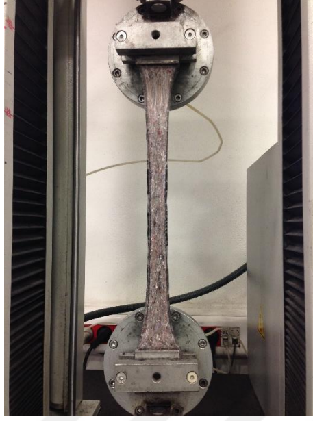
Şekil 4.4: Numuneye uygulanan kopma mukavemeti ve uzama testi.
