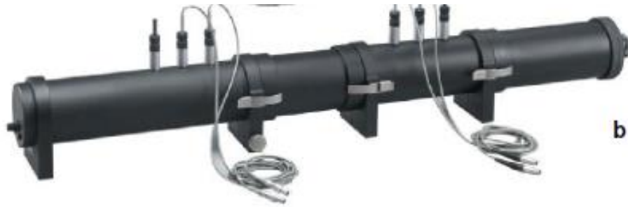
Şekil 3.18: Ses iletim kaybı için kullanılan iki tüplü empedans tüpü düzeneği [49].
