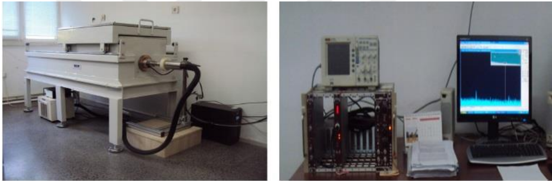
Şekil 4.3. ORTEC marka HPGe detektör ve gama spektrometre donanımı (Ertuğay, 2015).
