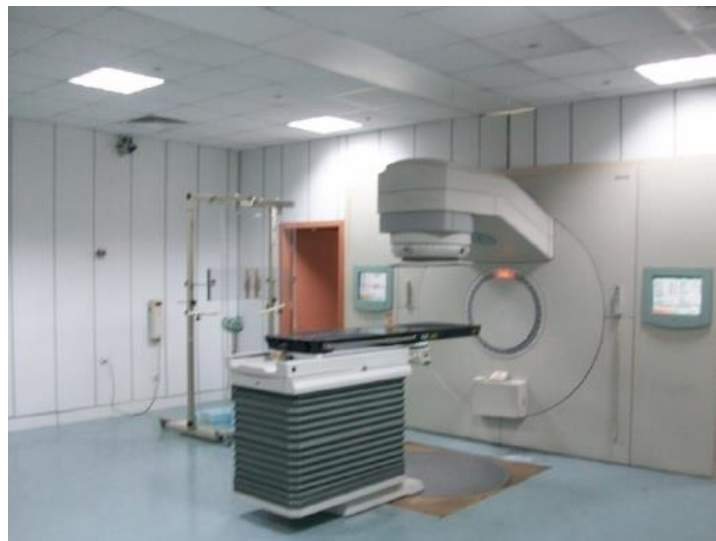
Şekil 4.1. Philips (Elekta TM Synergy) SLI-25 marka klinik elektron lineer hızlandırıcı.
