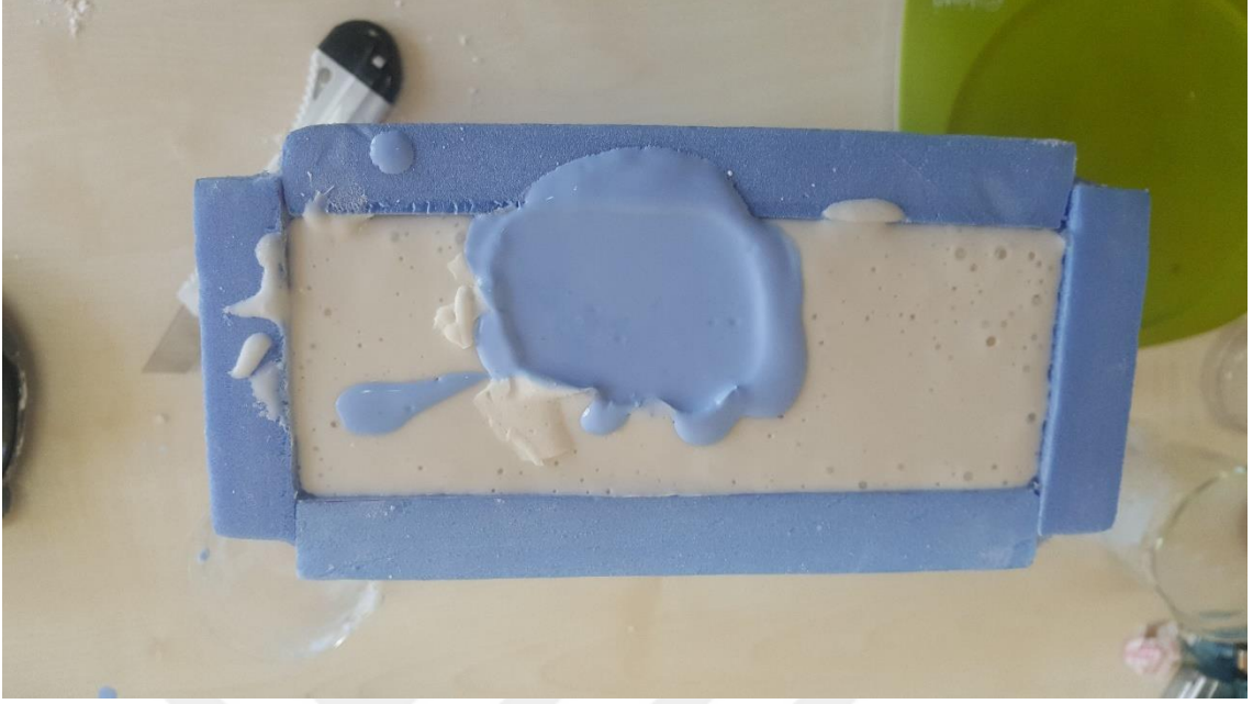
Şekil 3.4 Kalıp içerisine alçı sıvısının dökülmesi.
