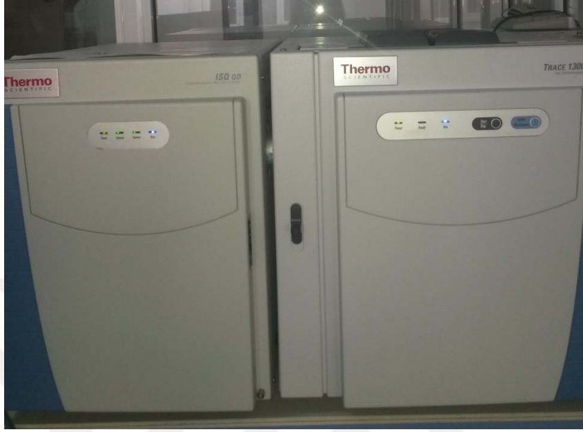
Şekil 2.2 Thermo Scientific marka Trace 1300 GC ve Thermo Scientific ISQ-QD Single Quadrupole MS cihazı (Kişisel arşiv, 2017)
