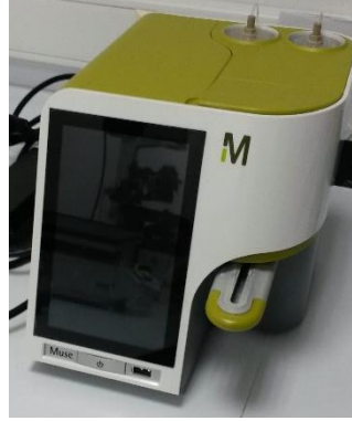
Şekil 18: Hücre sayımı ve canlılık ile hücre döngüsünde kullanılan Muse cihazı.
