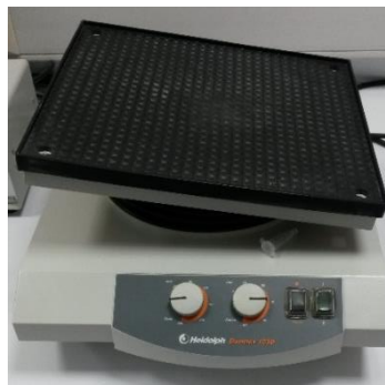
Şekil 17: Yüzeydeki hidrojelini eşit olarak yayılması için kullanılan çalkalayıcı
