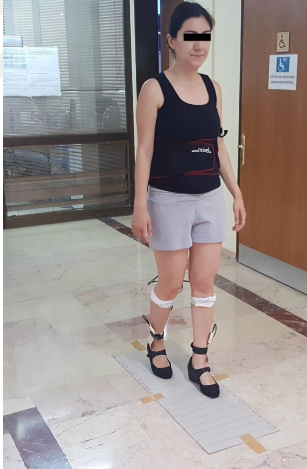
Şekil 5: Yürüme sırasında Pedar sistemi
