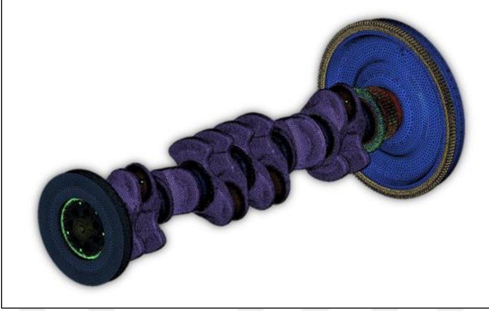
Şekil 3.33 : Krank mili sonlu elemanlar modeli.
