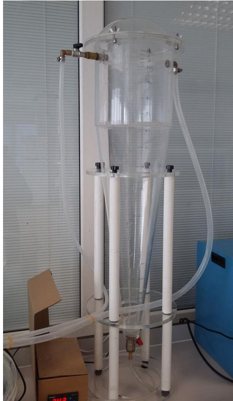
Şekil 4.4 Devridaimli Çöktürme sistemi
