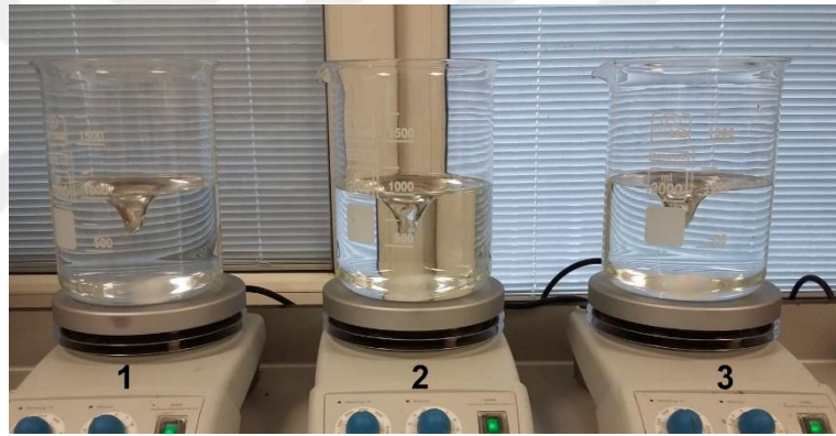
řekil 4.10 Sodyum bikarbonatın alkaliniteye etkisi deneyi
