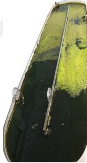
Şekil 4.22 Reaktör yüzeyinde mikroalg köpüğü oluşumu
