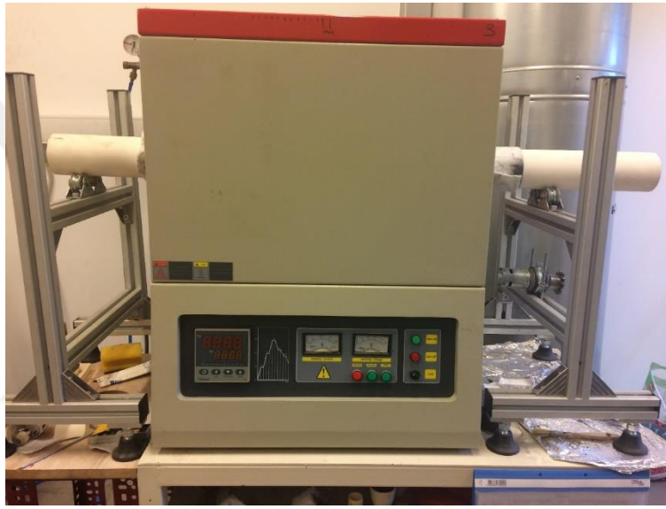
Şekil 5.1 : 1600 °C’ye ulaşabilen tüp fırın
