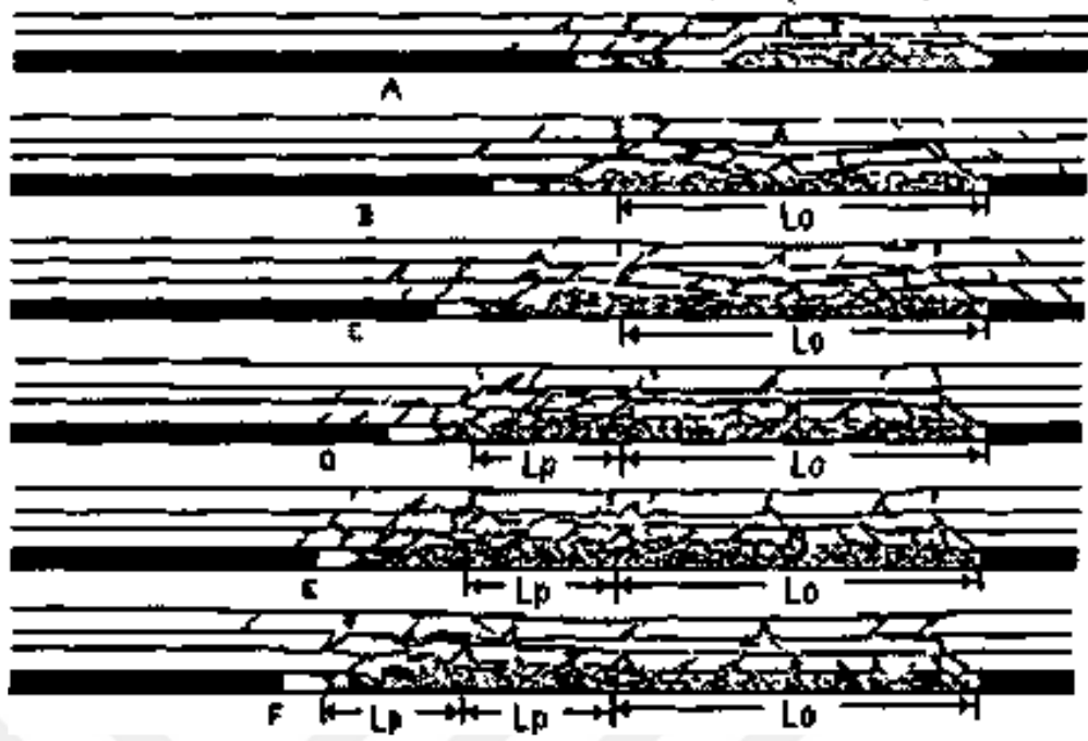
Şekil 4.3. İlk tavan yüklemesi ve periyodik tavan yüklemesi (Peng, 1984).
