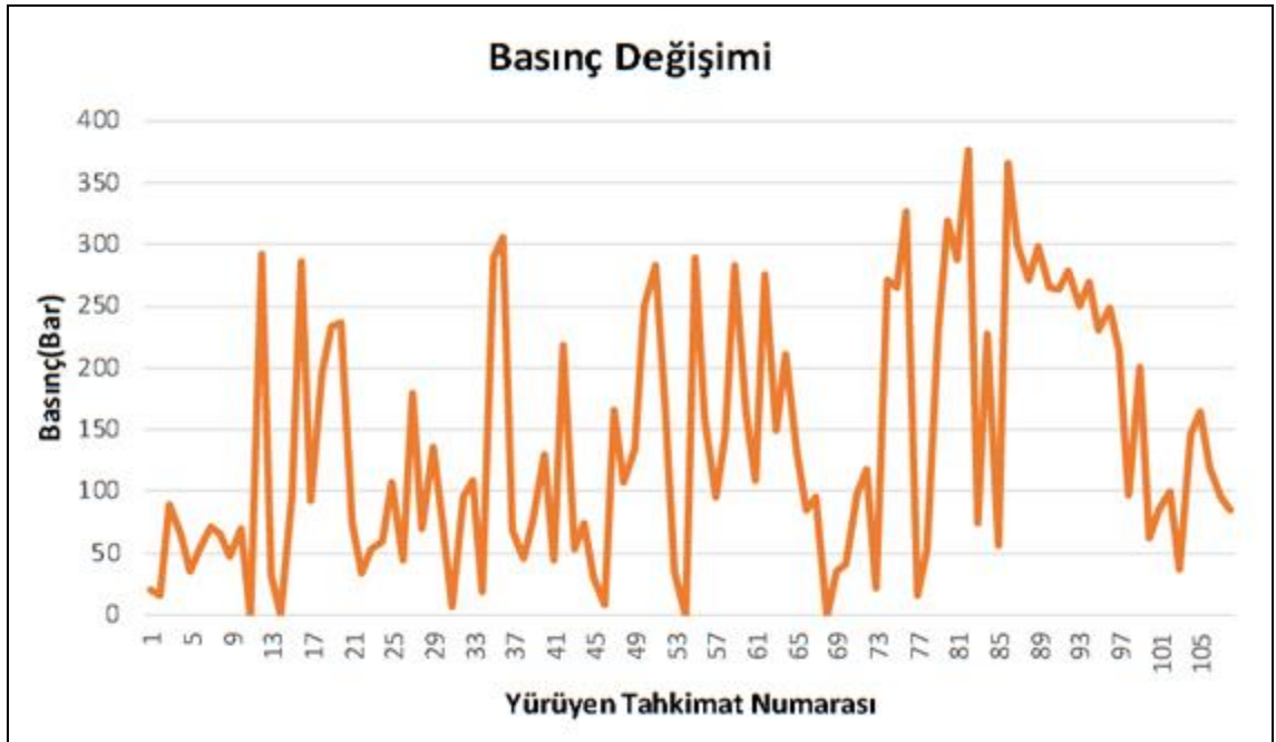
Şekil 6.9a. M2 Panosunda bulunan uzunayağın üretime başladığı ilk anda (07.08.2017) ayak içindeki YTÜ’lerin içindeki hidrolik basınç değişimleri.
