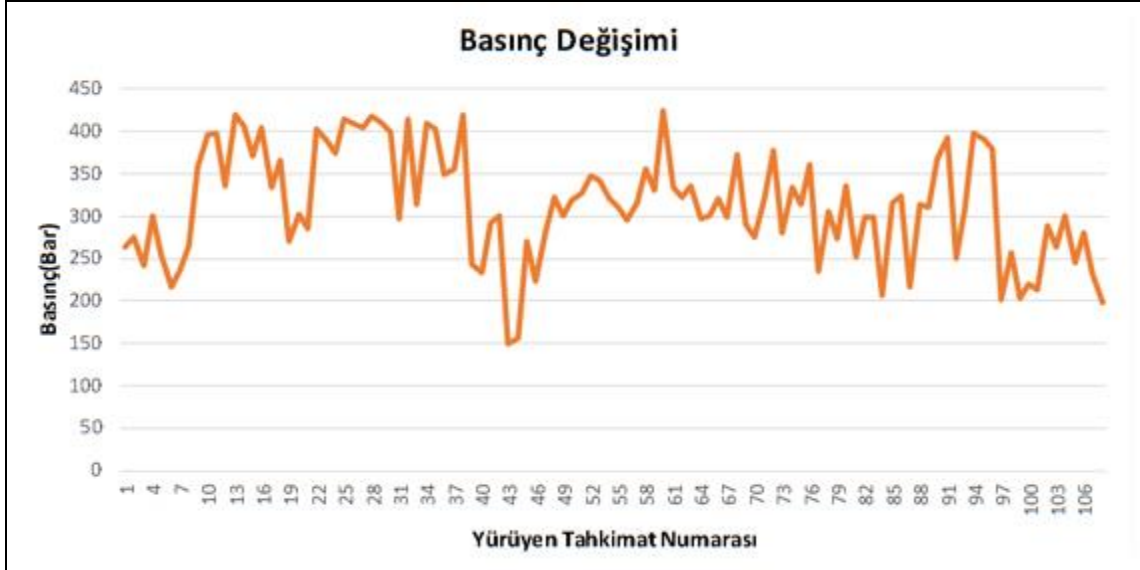
Şekil 6.9d. M2 Panosunda bulunan uzunayağın üretime başladığı ilk anda (21.08.2017) ayak içindeki YTÜ'ler içindeki hidrolik basınç değişimleri.
