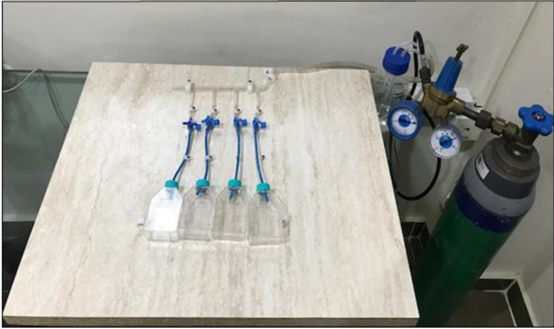
Şekil 3.13: Gaz karışımlarının uygulandığı sistem.
