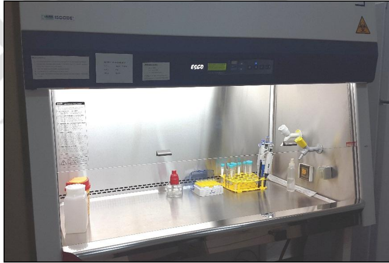
Şekil 3.2: Laminar akım kabini (ESCO Sentinel Gold Microprocessor Control System, USA).
