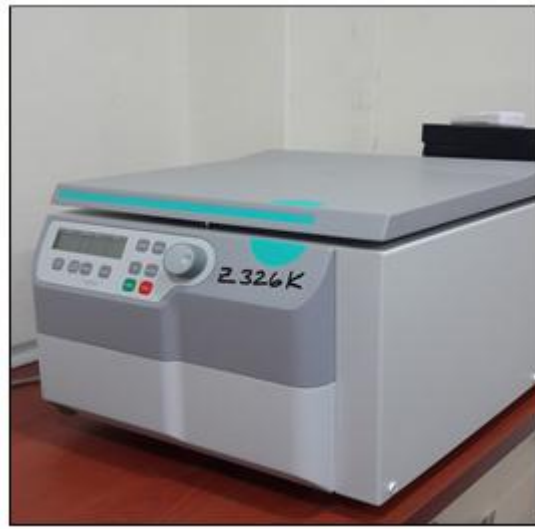
Şekil 3.6: Soğutmalı santrifüj (Z326K - Hermle Labortechnik).
