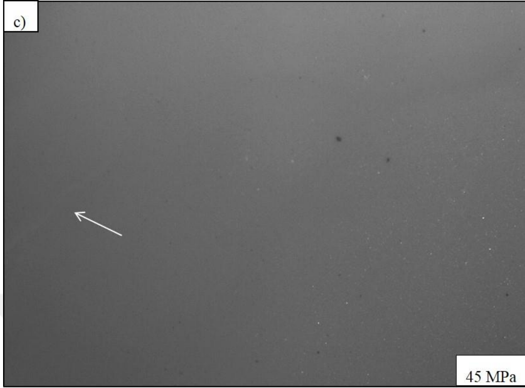
Şekil 5.18. (Devamı) 65 (a), 55 (b), 45 (c) MPa basınç altında sinterlenen numune yüzeylerinin optik mikroskop görüntüleri
