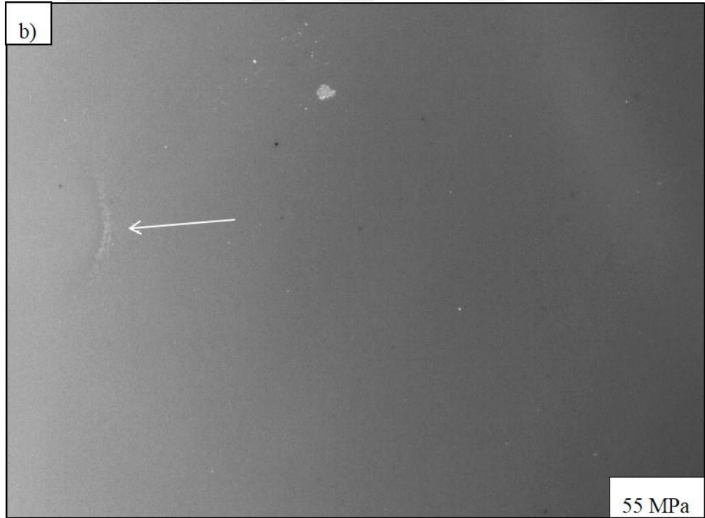
Şekil 5.17. 65 (a), 55 (b), 45 (c) MPa basınç altında sinterlenen numune yüzeylerinin optik mikroskop görüntüleri
