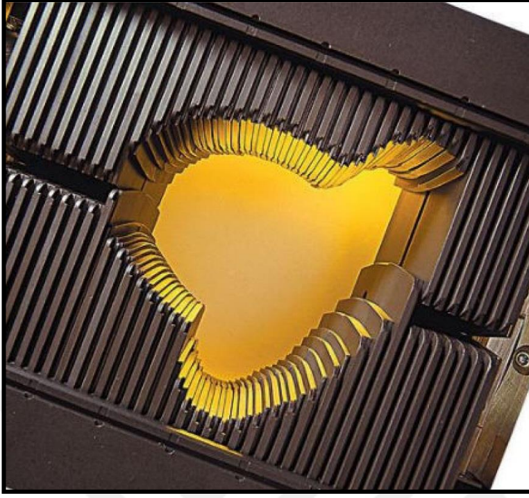
Şekil 2.1. Çok Yapraklı Kolimatör (ÇYK) sistemi
