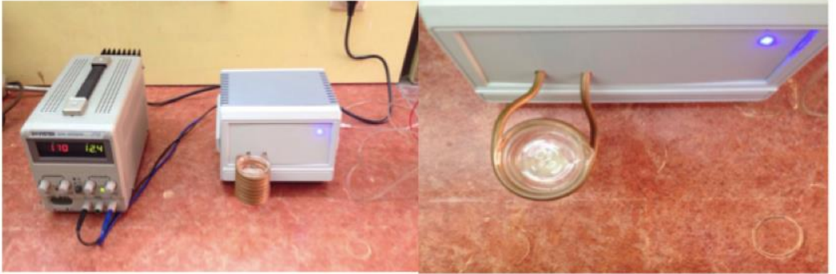
Şekil 3.13: Manyetik alanda şişme ölçümlerinde kullanılan manyetik alan üretici sistemi.
