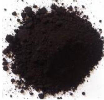
Şekil 3. 5: Tez kapsamında kullanılan nano boyutlu manyetit.
