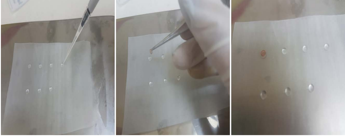
Resim 3.2. Parafilm üzerine 10 \mu l'lik damlacıklar oluşturularak TEM takip ve boyama yönteminin gerçekleştirilmesi
