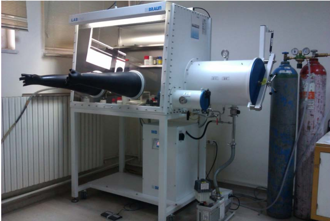
Resim 3.2. LABstar, MBRAUN marka Glove-Box cihazı
