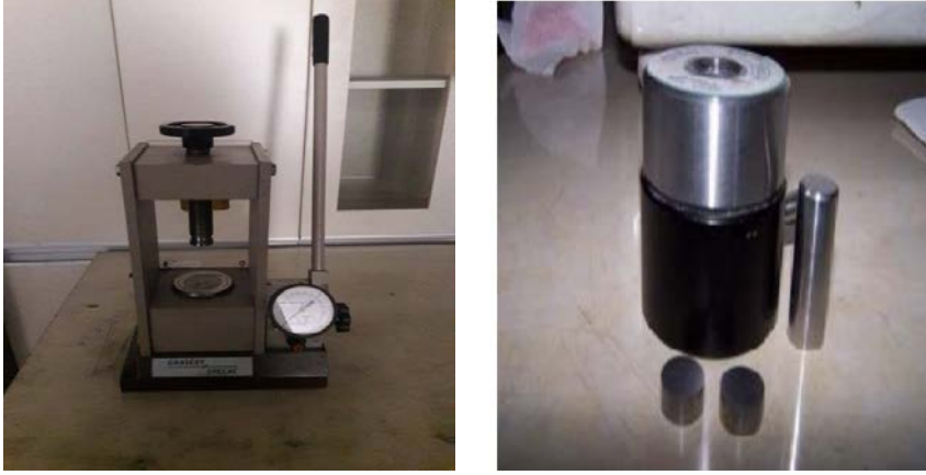
Resim 3.4. Pellet hazırlarken kullanılan ekipmanlar( presleme cihazı, pres kalıbı)
