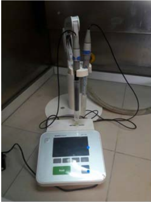
Resim 3.6. İyon metre, BF 4 - iyon seçici elektrot ve referans elektrot
