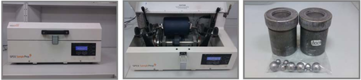
Resim 3.3. Speks (8000-D Mixer Mill) ve paslanmaz çelik reaksiyon hazneleri
