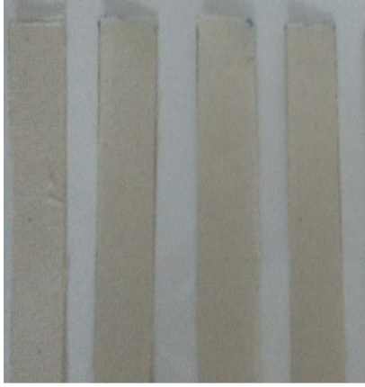
Resim 4.2. LOI testi için kullanılan kumaş örnekleri
