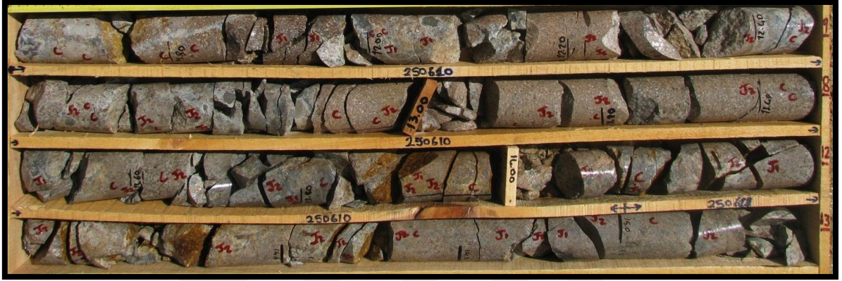
Şekil 5.9. Küçük bloklı zonun sondaj karotlarındaki görünümü
