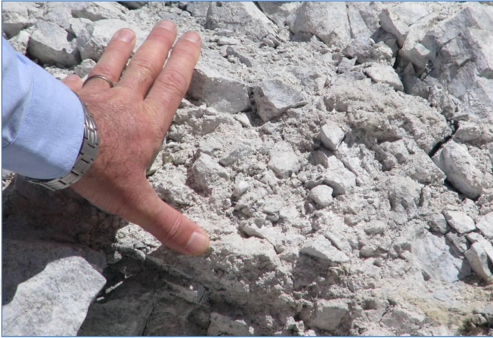
Şekil 5.15. Zayıf zonun açık ocakta yakından görünümü
