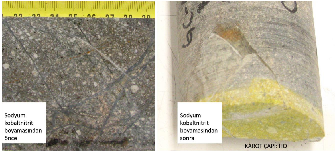
Şekil 5.28. Aynı karot numunesinin sodyum kobaltitinit boyaması öncesi ve sonrası görünümü
