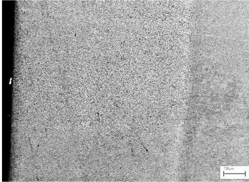
Şekil 6.26. N2_110A_NiAl_AH numunesi kaynak geçiş bölgesi ile birlikte SEM görüntüsü (300X).
