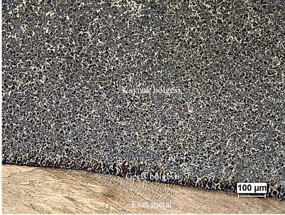
Şekil 6.55. N9_110A_NiAl_SH numunesi 100X büyütme.
