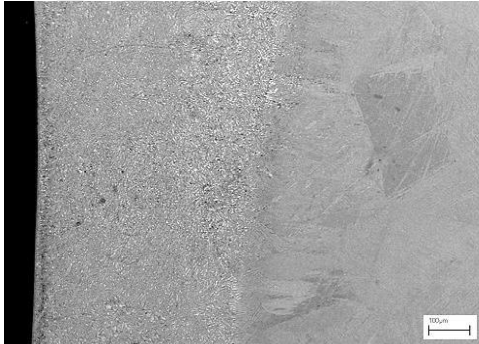
Şekil 6.34. N4_110A_NiAlNano_AH numunesi kaynak geçiş bölgesi ile birlikte SEM görüntüsü (300X).
