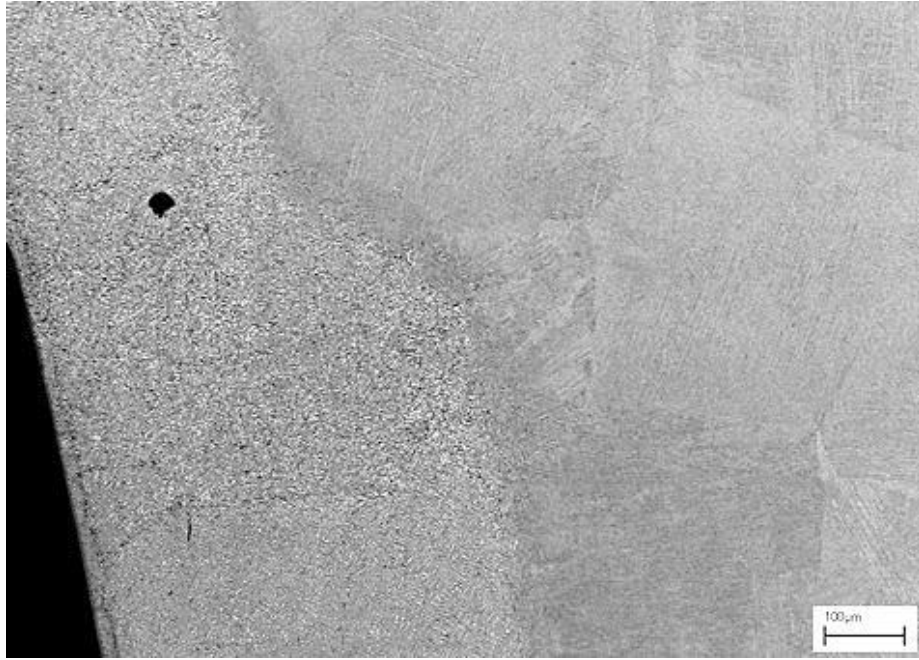
Şekil 6.30. N3_100A_NiAlNano_AH numunesi kaynak geçiş bölgesi ile birlikte SEM görüntüsü (300X).
