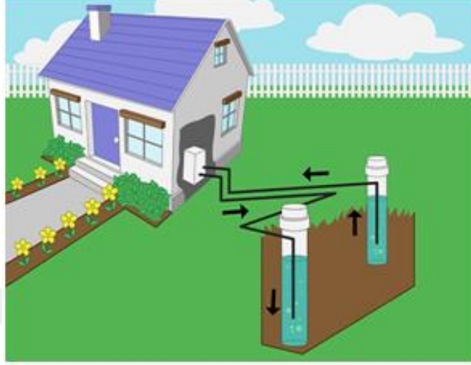
Şekil 2.10 Isı kaynağı olarak yeraltı suyu (url-6)
