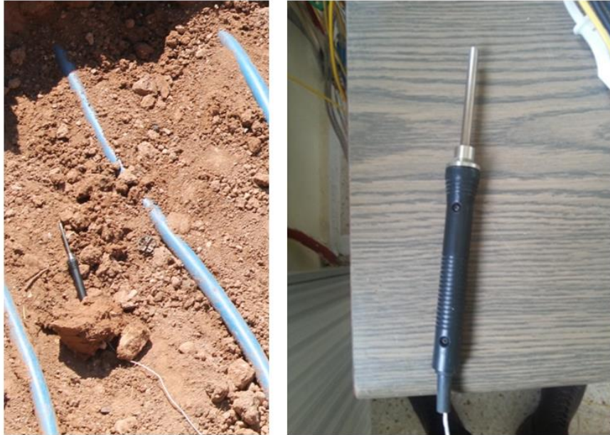
Şekil 3.16 Toprak sıcaklık ölçüm probu
