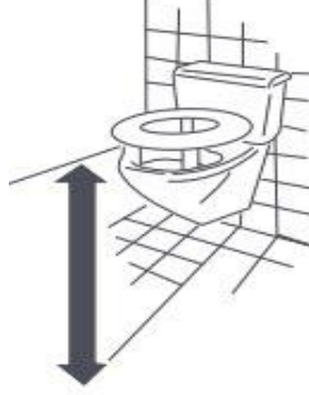
Şekil 3.87. Yüksekliği Ayarlanabilir Adaptör Takılmış Klozet Örneği 242
