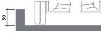
Şekil 3.23. Rampalarda Kenar Bordürü 155
