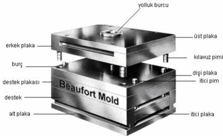
Şekil 3.8 : Plastik enjeksiyon kalıp elemanları [5].
