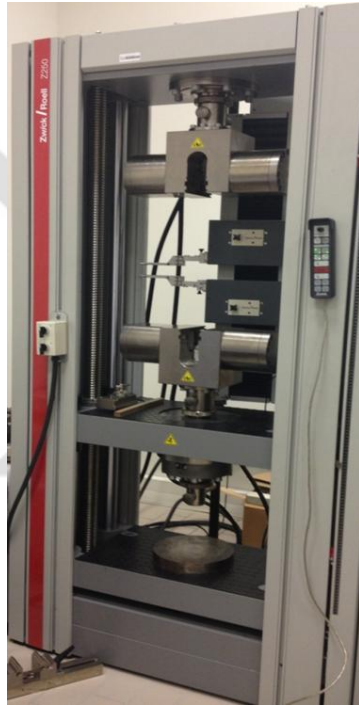
Şekil 1-10: Sürtünme Testinin Yapıldığı Cihaz
