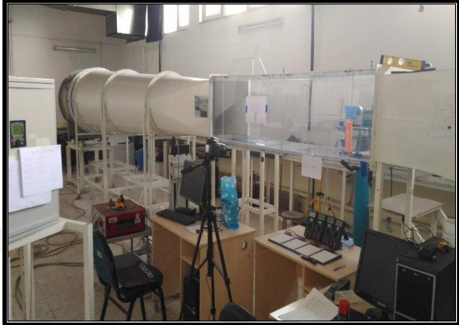
Şekil 2. 4. Deneylerin gerçekleştirildiği rüzgâr tüneli.
