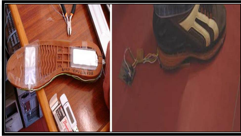
Şekil 1. 2. Ayakkabı tabanına yerleştirilen piezoelektrik malzemeler[18].
