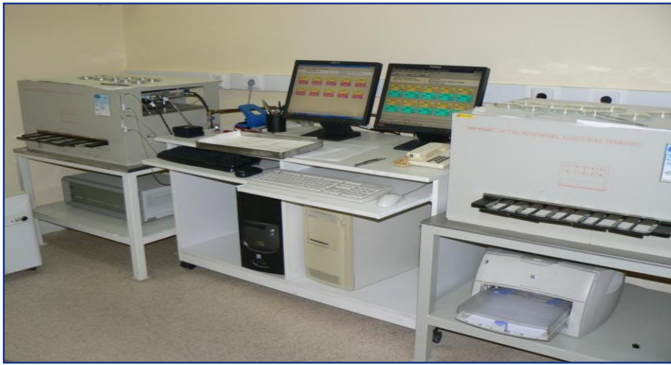
Şekil 3-8: Berthol LB-770 model gaz akışlı düşük fon sayımlı 10 kanallı orantılı sayıcı.
