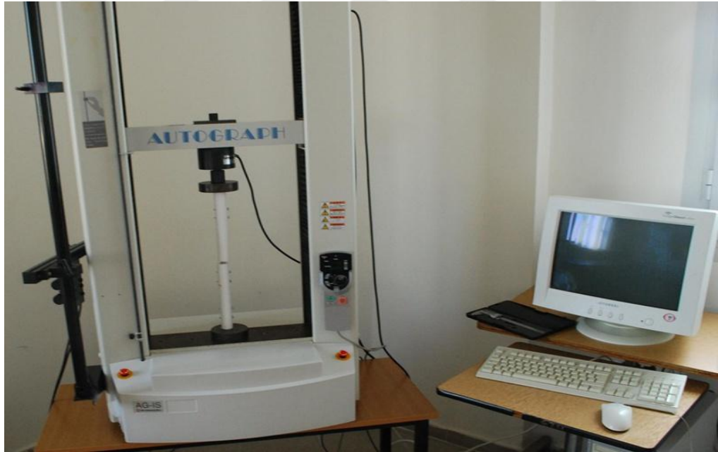
Şekil 49. Biyomekanik testler Shimadzu (AG-I 10kN, Japan) test cihazında gerçekleştirilmiştir.
