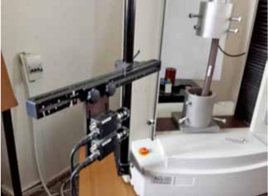
Şekil 50. Aksiyel yüklemde basma (compression) deneyi.
