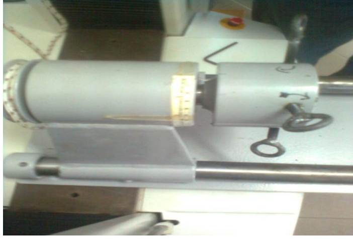
Şekil 52. Burulma cihazı üzerinde değeri okunduğu ölçek
