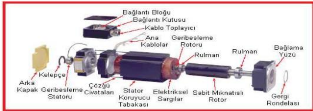
Şekil 6. Fırçasız bir DC motorun içyapısı
