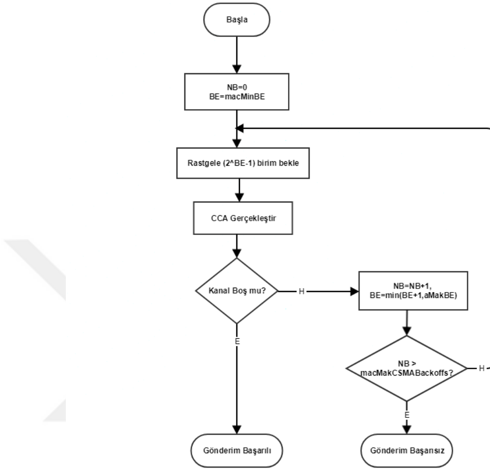
Şekil 2.5. Slotsuz CSMA/CA akış diyagramı (Al Rasyid ve ark., 2014).
