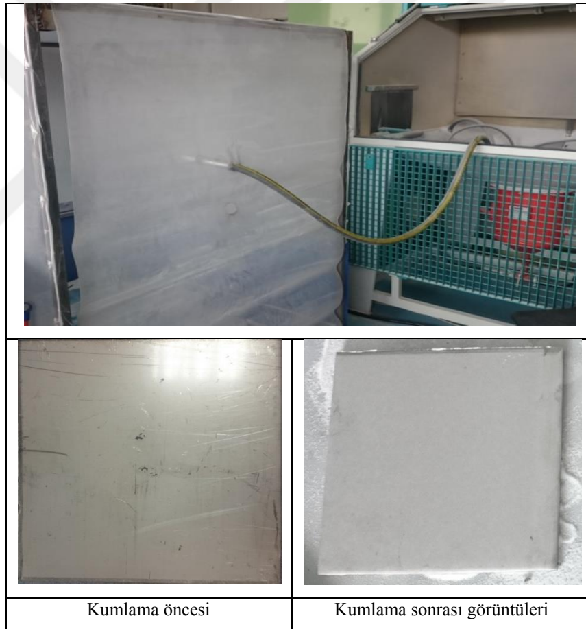
Şekil 5.1. Kumlama kabini ve kumlanmış numune görüntüsü
