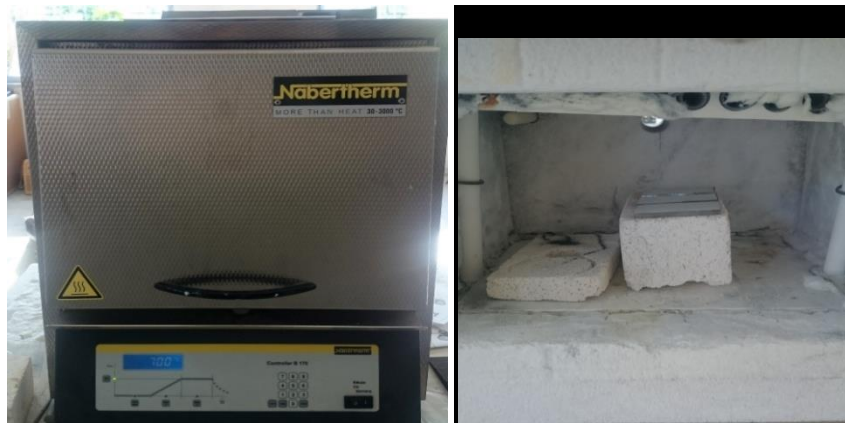
Şekil 5.3. Yüksek sıcaklık fırını ve numune yerleştirme görüntüsü
