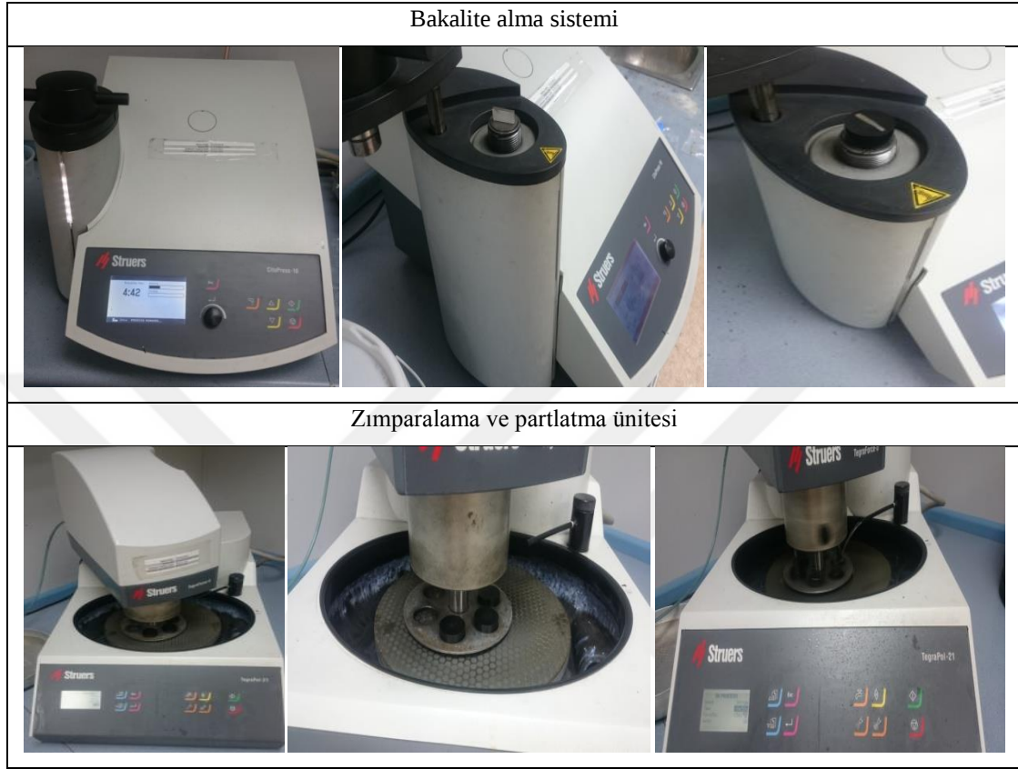
Şekil 5.5. Numuneyi bakalite alma , zımparalama ve parlatma ünitesi
