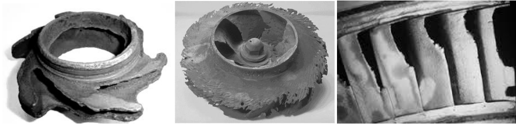
Şekil 2.2. Eroziv aşınmaya maruz kalmış parçalar
