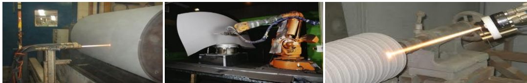
Şekil 3.7. HVOF prosesi ile kaplama uygulamalarına örnekler
