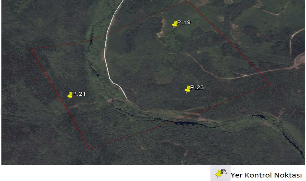
Şekil 3. 6 Çalışma alanı 1 için Yer Kontrol Noktalarının model bazında tesisinin ve çalışma alanı sınırlarının Google Earth programında gösterimi
