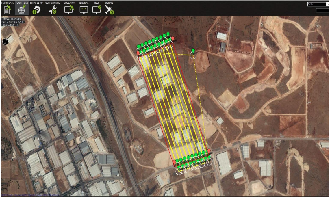
Şekil 3. 11 Çalışma alanı 2 için tanımlanmış proje alanı ve İHA uçuş planının uçuş kontrol Mission Planner programında gösterimi
