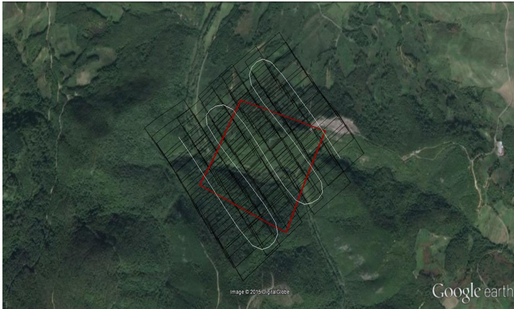
Şekil 3. 8 Çalışma alanı 1 için tanımlanmış proje alanı ve İHA uçuş planının Google Earth programında gösterimi
