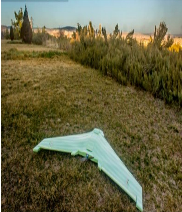
Şekil 3. 5 Çalışma alanı 2' de veri toplamak için kullanılan sabit kanatlı İHA ve sabit kanatlı İHA' ya monte edilmiş sayısal kamera
