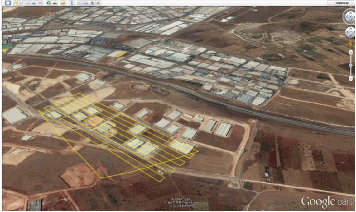
Şekil 3. 10 Çalışma alanı 2 için tanımlanmış proje alanı ve İHA uçuş planının Google Earth programında gösterimi
